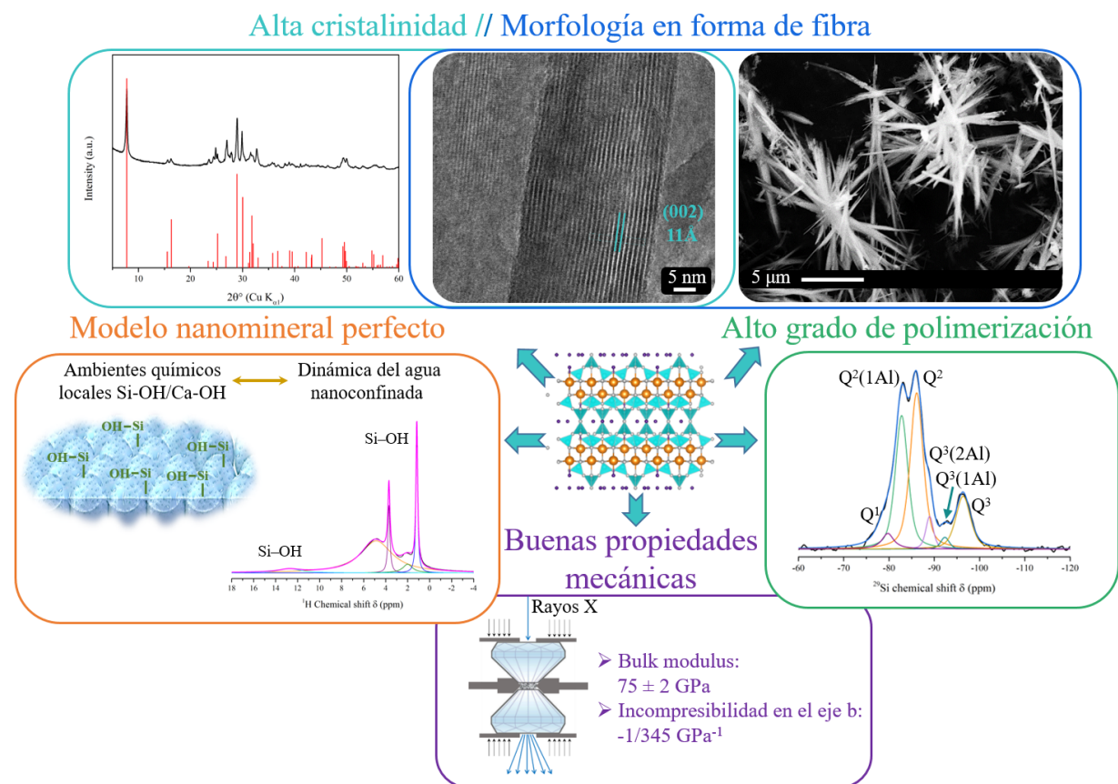
Figure 6: Diagrama representativo de las propiedades fisicoquímicas de la tobermorita sintetizada en agua suercrítica en 8 s.
