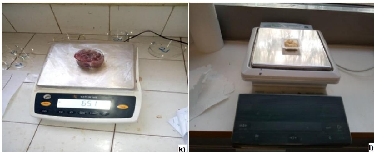
**Figure 10:** k) prélèvement muscle, l) pesée poids sec après broyage
