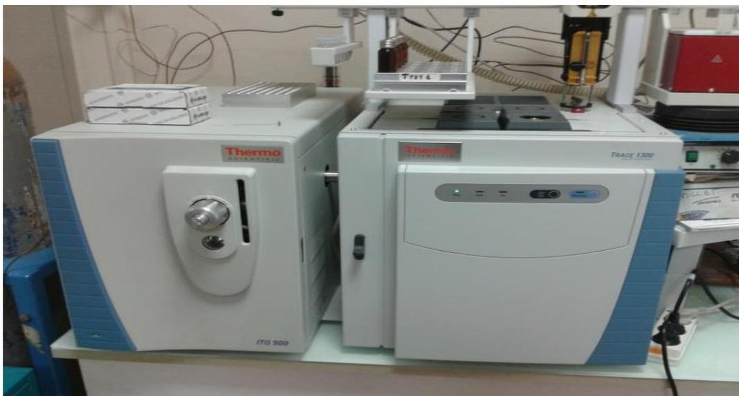
**Figure 14:** Appareillage analytique GC/MSMS
