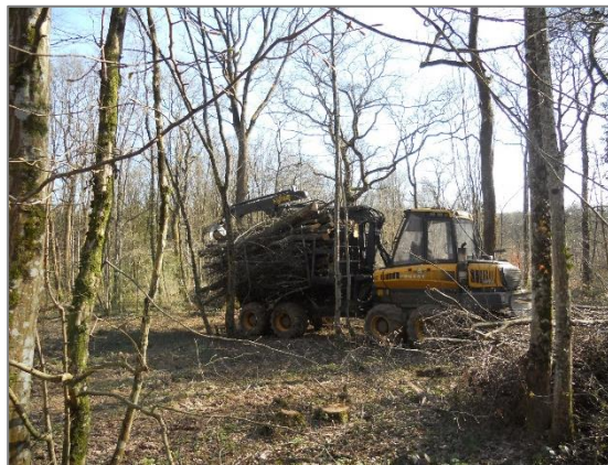
2- Débardage (effectué, ici, à l'aide d'un porteur)
