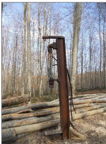
Photo 4 - Fendeuse verticale d'un affouagiste d'Oloron (P-A)
