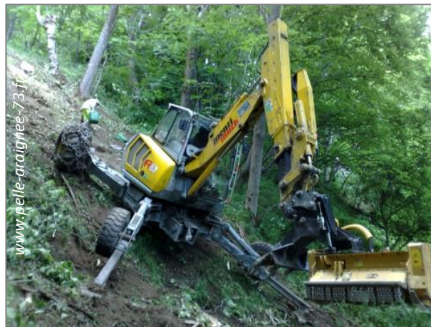
Photo 34 - Exemple d'une pelle araignée
