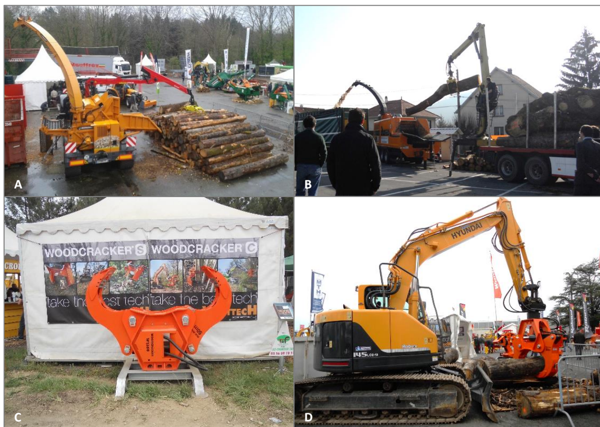
Photo 26 - Matériels de transformation des grumes de gros diamètres en plaquettes
