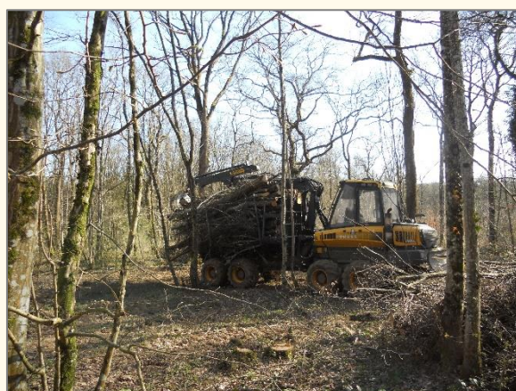
Photo C - Porteur en train de débarder du bois à vocation énergétique
