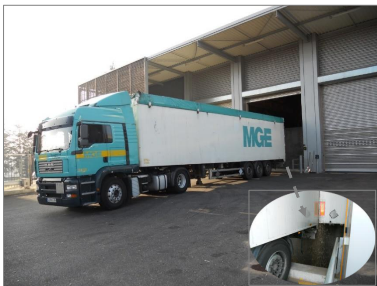
Photo 38 - Camion à fond mouvant de 90 m 3 en train de décharger sa cargaison dans un silo
