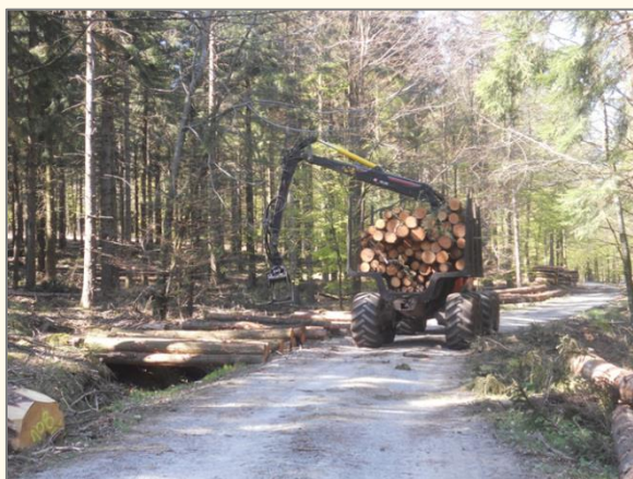
Photo A- Porteur en train de charger latéralement des billons à l'aide de son grappin
