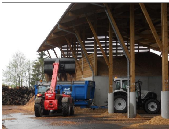
5- Chargement des plaquettes, dans une benne agricole, à l'aide d'un manitou
