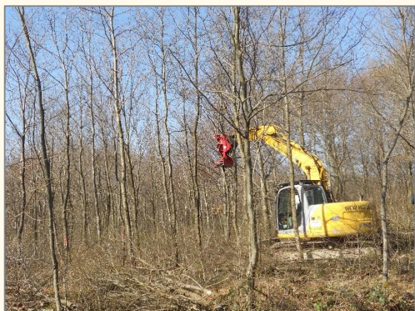
Photo D - Dépressage à l'aide d'une cisaille bois-énergie
