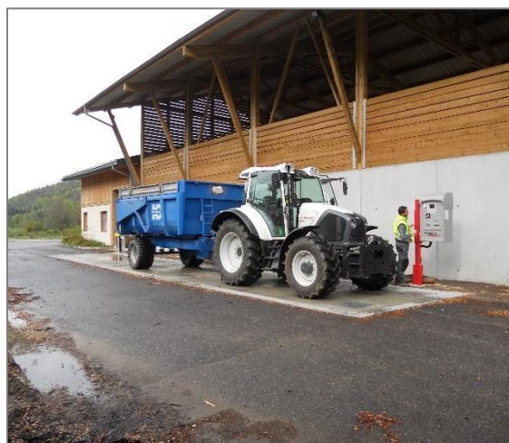
Photo 42 - Exemple de pont à bascule
