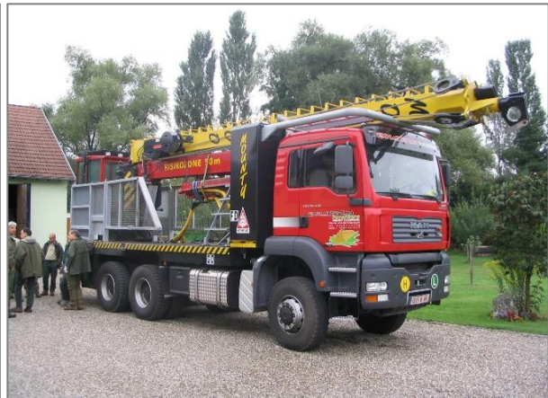
Photo 36 - Modèle de câble-mât sur camion
