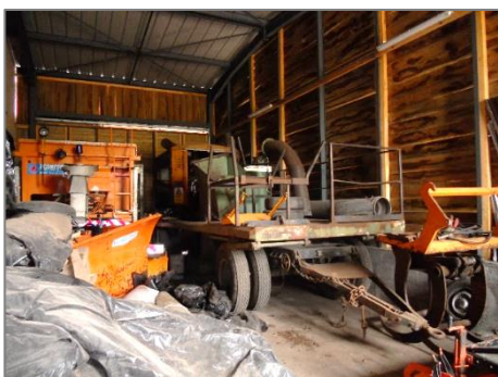
Photo 18 - Le broyeur de fortune fabriqué par les services techniques d'Hadol
