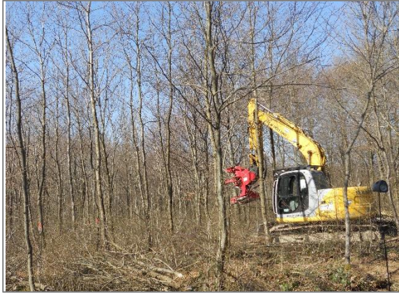
1- Abattage (réalisé, ici, à l'aide d'une cisaille spéciale BE)
