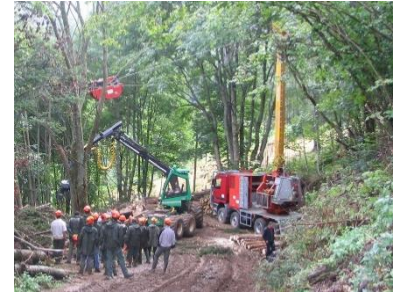
Photo A - Câble-mât sur camion (engin rouge et jaune) et engin de reprise (vert)
