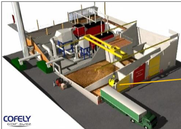
Figure 33 - Coupe schématique d'une chaufferie de grande puissance
