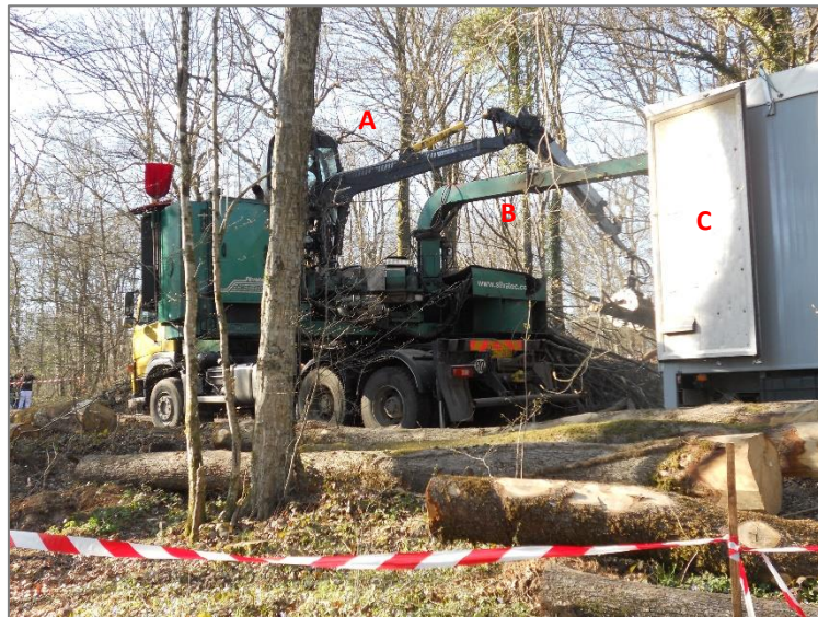
Photo 39- Exemple de broyeur forestier monté sur camion.
