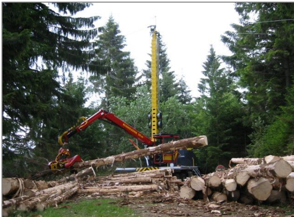
Photo 35 - Exemple de câble-mât équipé d'une grue et d'une tête de façonnage
