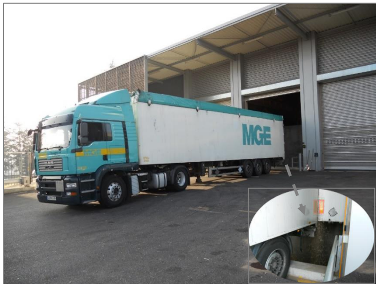
Photo 38 - Camion à fond mouvant de 90 m 3 en train de décharger sa cargaison dans un silo
