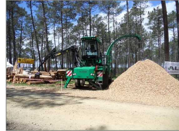
3- Transformation du bois en plaquettes à l'aide d'une déchiqueteuse
