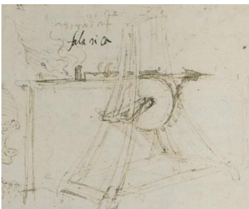
Macchina bellica che scaglia la falarica (c. 5v)
