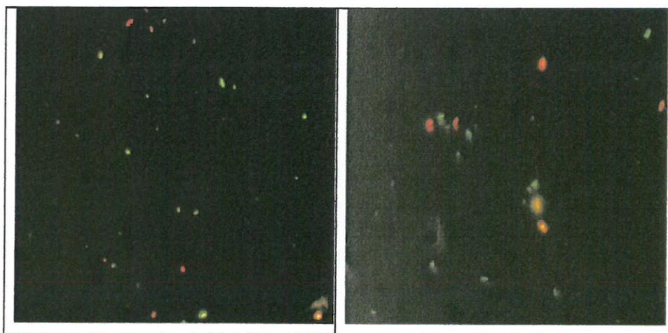
*Figure VI.9: Images obtenues par microscopie à fluorescence après 2 heures de polarisation à +1,5 V/ECS dans l'eau de mer + 0,1(à gauche) et 0,05% (à droite) d'albumine SAB.*
