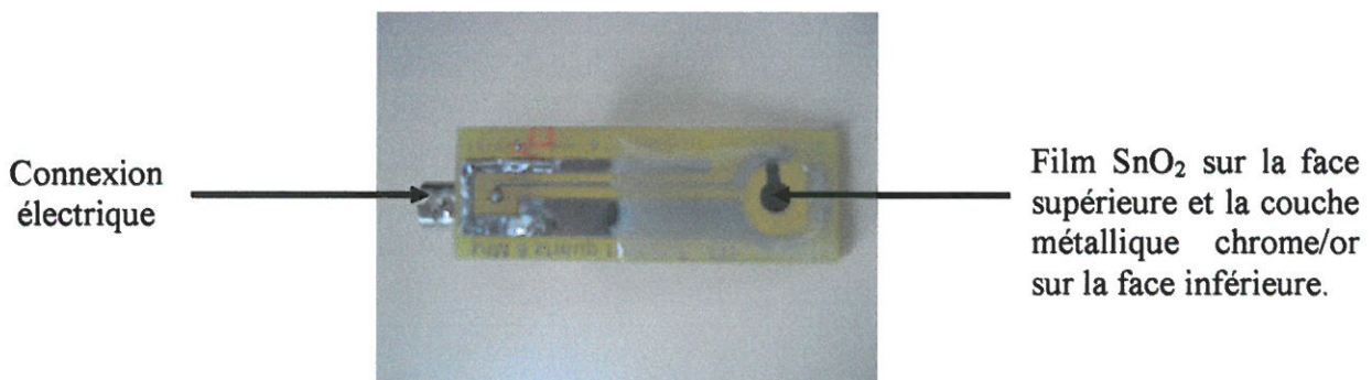
Figure.II. 3 : photo d'une électrode sur substrat de quartz avec son support et sa connectique.
