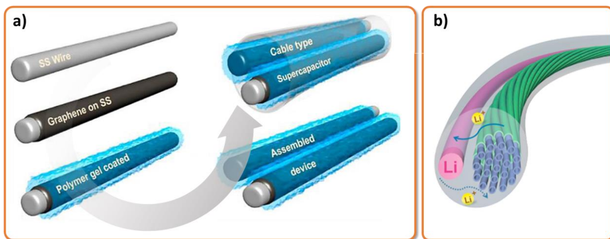
Figure I.37 : A) Exemples de mise en forme de matériaux 1D par assemblage d'ensembles coaxiaux à base de matériaux 1D enrobés puis encapsulés pour un système supercondensateur type-câble. B) Mise en forme d'un assemblage d'une batterie sous forme coaxiale avec l'anode de lithium métal et la cathode de nanotubes de carbones enroulée installée en parallèle [172].
