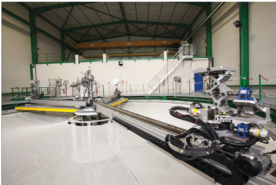
FIGURE 2.7 – Aire de recherche, avec la cible située au centre de la plateforme et ses bras rotatifs (irsn.fr).
