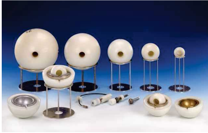
FIGURE 1.3 – Photo d’un ensemble de sphères de Bonner, percées jusqu’à leur centre pour y insérer un compteur proportionnel (ptb.de).
