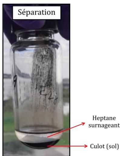
Figure 2.1 : Séparation des phases solides et liquides après centrifugation
