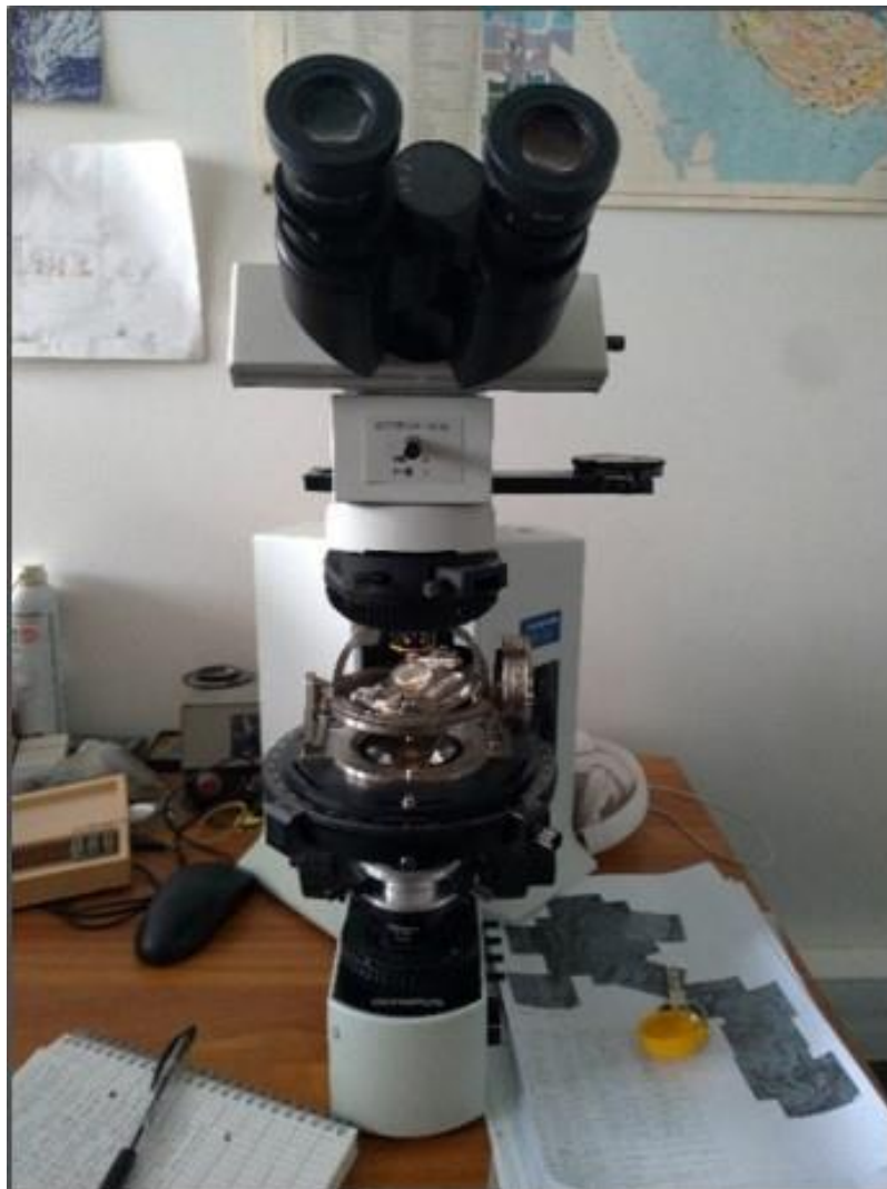
Figure 10: Photo de microscope muni d'une platine universelle
