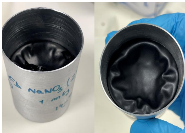
Figure 26 : Enrobé incorporant 25% de \text{NaNO}_3 conditionné dans un pot en aluminium à moitié rempli, après irradiation à 1 MGy
