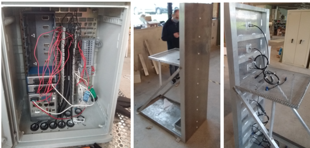
FIGURE 4.18 – Structure mobile pour l'étude des phénomènes de submersion côtiers. A gauche : le câblage du système de supervision. Au centre : la face avant de la structure avec les 9 capteurs de pression installés. A droite : la face arrière de la structure avec les capteurs à connecter.
