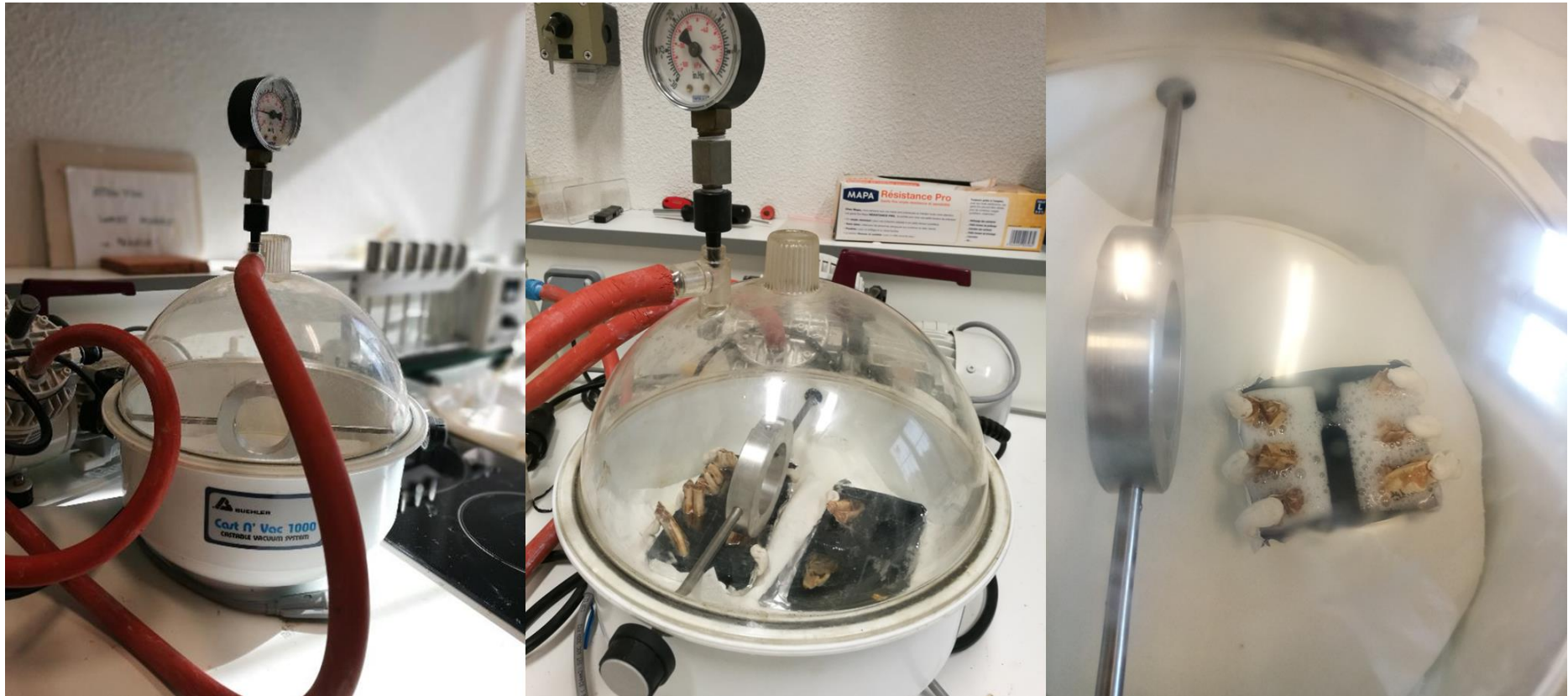
Figure 19 : Passages sous vide (cloche à vide). Les racines dentaires « moussent » en rejetant l'air et ce qui permet une meilleure imprégnation de la résine.
