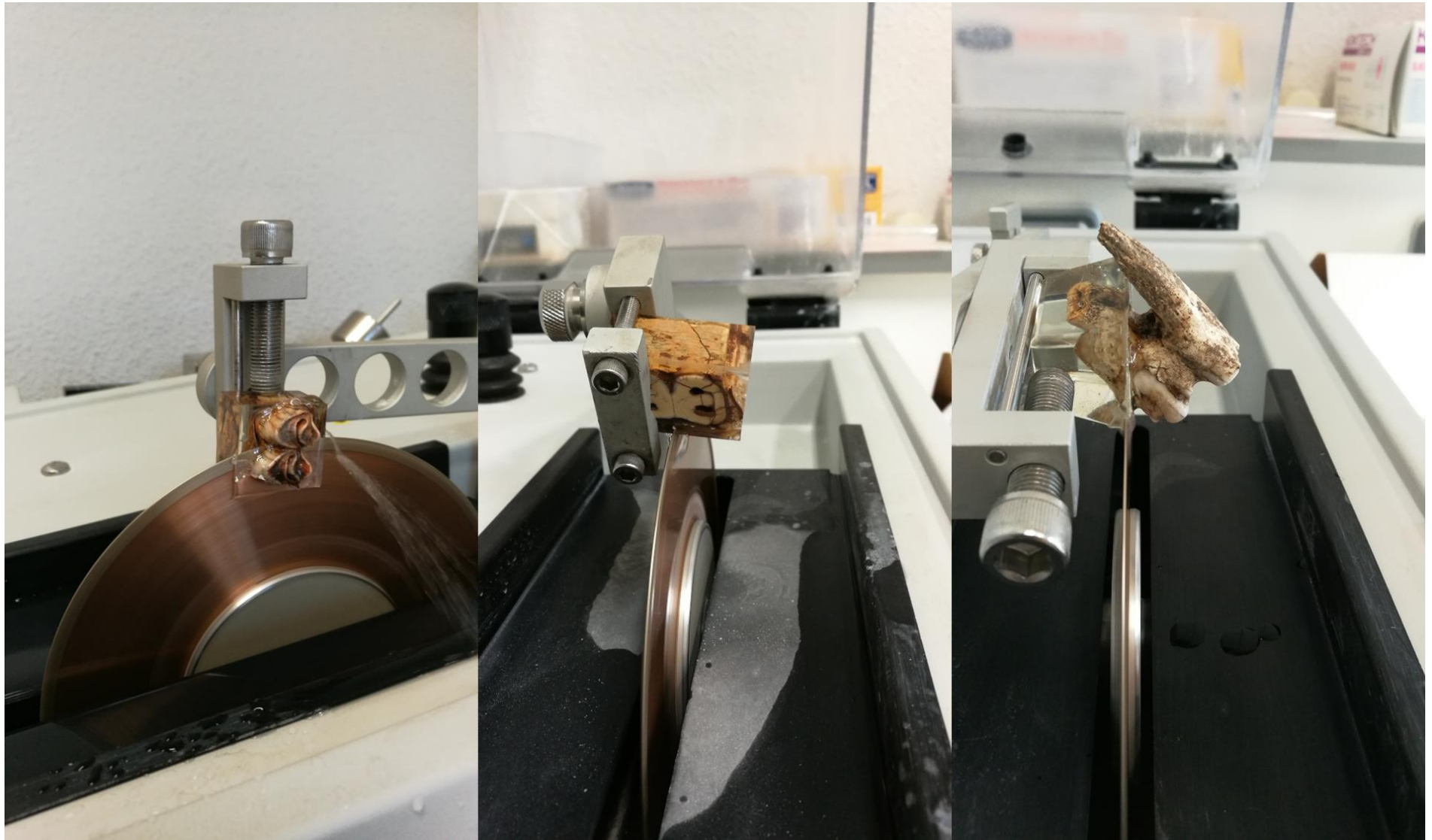
Figure 20 : Scie à rotation lente : séparation de la couronne puis des deux racines d'une molaire de cerf (gauche). Prélèvement ciblé d'une racine de bison (droite).
