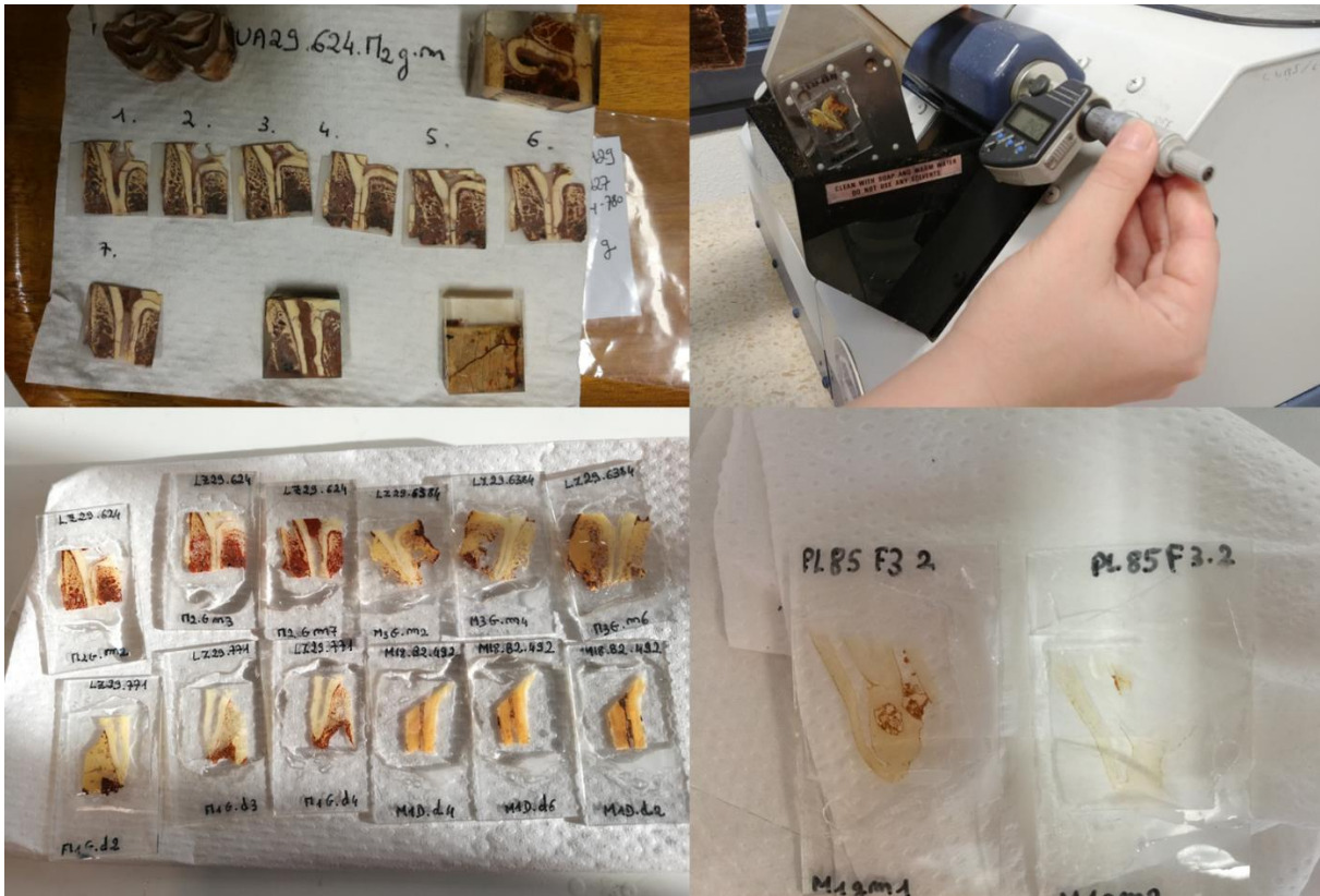
Figure 23 : Couronne, blocs avec les racines et sections extraites d'une molaire mandibulaire de cerf. Sections de racines de molaires mandibulaires (cerf) montées sur une lame de verre. Sections en cours d'amincissement à l'aide d'une rectifieuse. Sections après abrasion jusqu'à l'épaisseur désirée.
