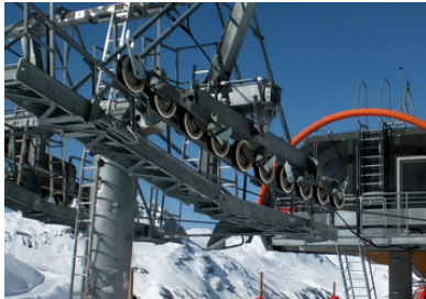
(a) Compression roller battery - TSD4 Les pyramides / Les trois vallées
