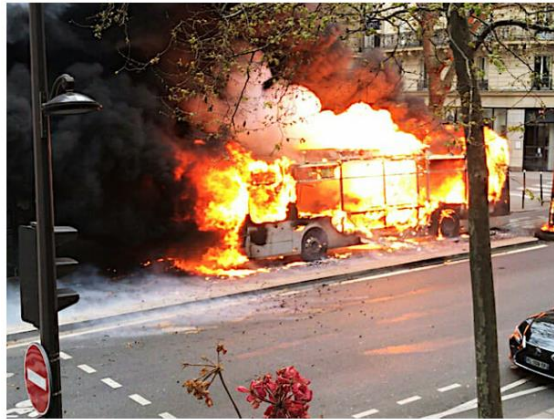
Figure 1-6 : Incendie d'un autobus électrique RATP suite à un emballement thermique, sur le boulevard Saint-Germain à Paris le lundi 4 avril 2022 [12].
