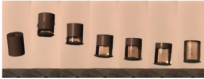
FIGURE I.0.6 : D'après CELESTINI et al. (2020). Images de projectiles de longueur L = 15 mm éjectés par le même engin de type catapulte de fréquence f = 76 Hz. À gauche un projectile sans couche molle, à droite un projectile totalement mou et entre les deux différentes proportions de matériau mou. Après éjection à vitesse V_e , le centre de masse des projectiles n'est soumis qu'à la gravité. Chaque projectile atteint alors une hauteur maximale H reliée à la vitesse d'éjection par la relation V_e = \sqrt{2gH} . Les projectiles atteignent des hauteurs H différentes donc leur vitesse d'éjection V_e dépend de l'épaisseur de couche molle.
