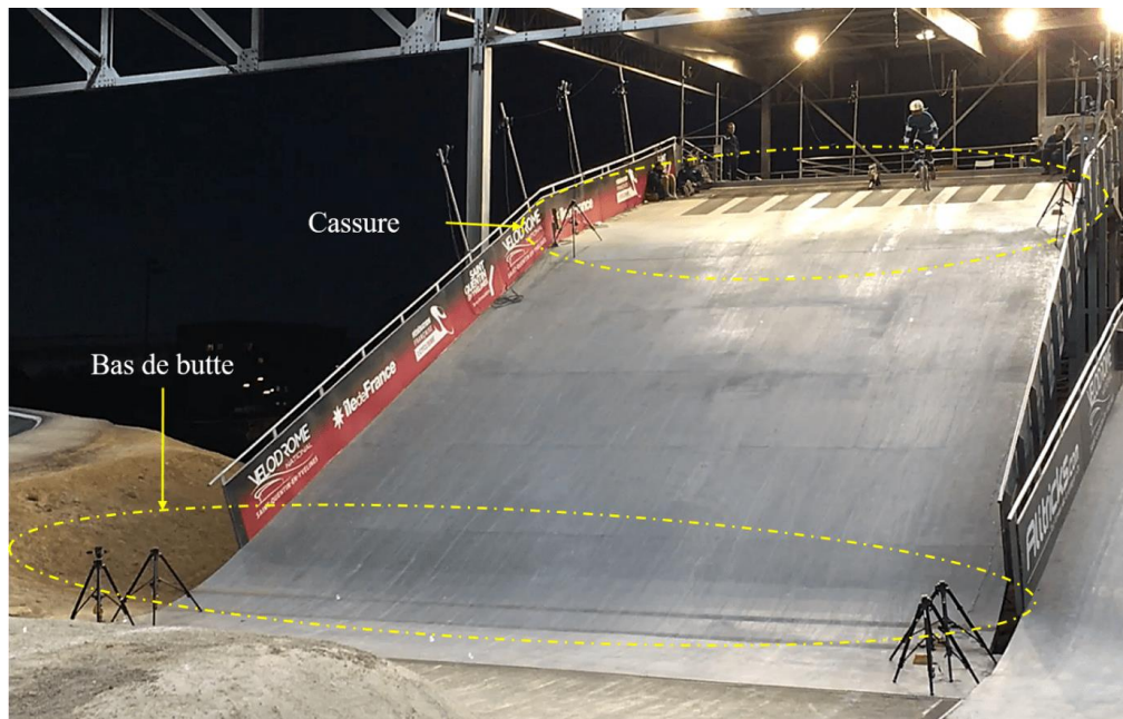
Figure 2.11 : Emplacement des cellules sur la butte de départ
