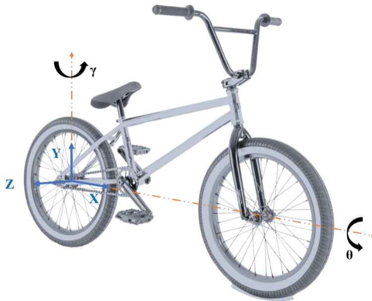
Figure 5.7: Repère du vélo positionné sur la roue arrière. L'axe x est défini comme l'axe antéropostérieur du vélo passant par les deux axes des roues. L'axe z correspond à l'axe transverse porté par l'axe de la roue arrière. Enfin, l'axe y correspond à l'axe vertical pour former un trièdre direct. Le mouvement de roulis du vélo correspond donc au mouvement de rotation du vélo autour de l'axe x ( \theta ), tandis que le mouvement de lacet correspond au mouvement de rotation autour de l'axe y ( \gamma )
