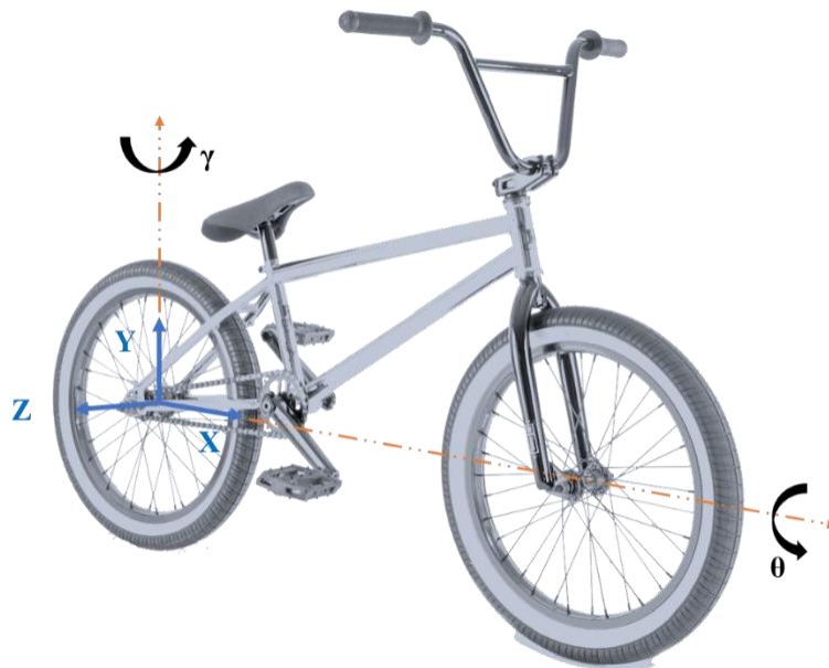
15 Figure 5.7: Repère du vélo positionné sur la roue arrière. L'axe x est défini comme l'axe antéropostérieur du vélo passant par les deux axes des roues. L'axe z correspond à l'axe transverse porté par l'axe de la roue arrière. Enfin, l'axe y correspond à l'axe vertical pour former un trièdre direct. Le mouvement de roulis du vélo correspond donc au mouvement de rotation du vélo autour de l'axe x ( \theta ), tandis que le mouvement de lacet correspond au mouvement de rotation autour de l'axe y ( \gamma )
