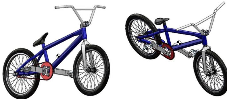
10 Figure 3.5: Maquette CAO du vélo, après toutes les modifications dans SolidWorks. Le point visible au niveau du cadre inférieur renseigne sur la position du centre de gravité du vélo.
