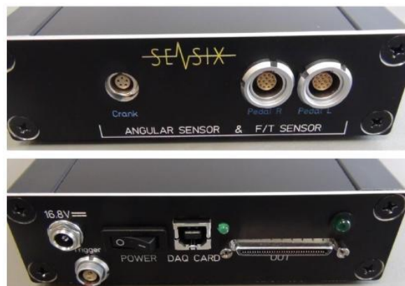
Figure 2.2: Boîtier de traitement et de centralisation de données avant de les transmettre à la tablette sur la DAQ-Cord.
