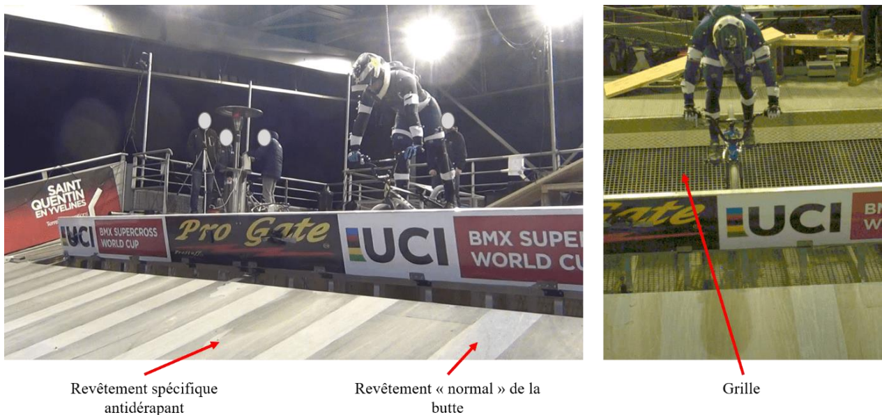
Figure 3.11 : Butte de départ sous différents angles afin de voir les trois revêtements différents: la grille au départ, un revêtement antidérapant (lequel définit les couloirs de départ) et le revêtement normal de la butte.
