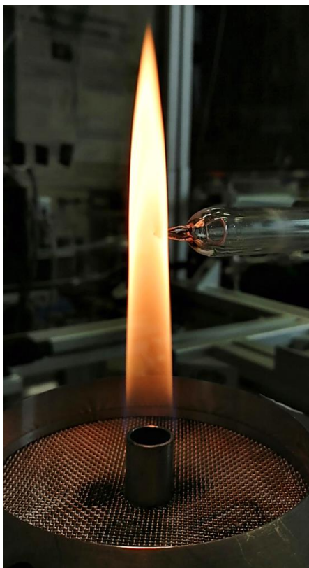
Figure 2.4 : photo de la flamme de diffusion laminaire méthane/air comprenant la sonde en quartz.
