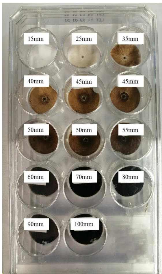
Figure 2.32 : échantillons prélevés sur des filtres en microfibre de verre en fonction de la hauteur dans la flamme pour les analyses RPE.
