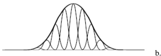
Figure 2.26 : a. raie homogène. b. raie inhomogène.
