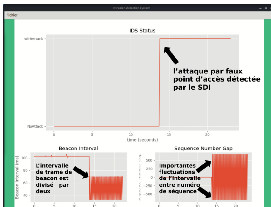
FIGURE 4.6 – SDI - Situation avec l'attaque par faux point d'accès
