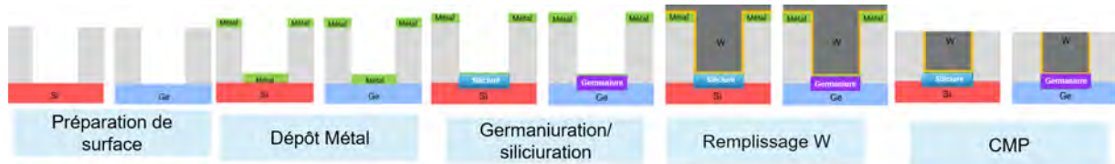
FIGURE 2.1 – Schéma des co-procédés à développer pour la co-intégration des contacts sur Si et Ge.
