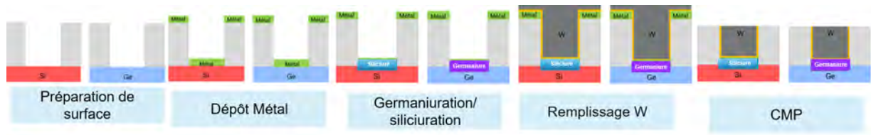
FIGURE 1.8 – Schéma des co-procédés à développer pour la co-intégration des contacts sur Si et Ge
