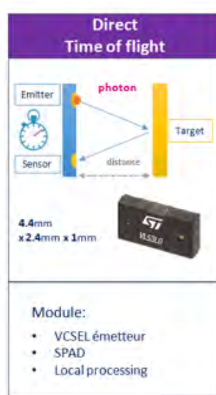
FIGURE 1.1 – Illustration de la technologie Time-Of-Flight à STMicroelectronics et schéma de son fonctionnement.
