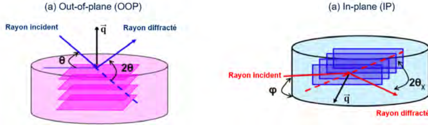
FIGURE 2.16 – Schéma des configurations (a) out-of-plane et (b) in-plane d'une analyse XRD (adapté de (20)).
