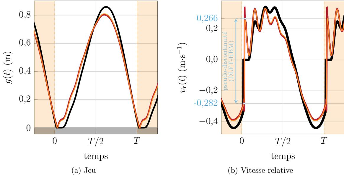
FIGURE IV.7 – Jeux et vitesses relatives obtenus par la DLFT-HBM ( $N_t = 4000$ ), LCP-HBM ( $N_t = 8000$ ) et IT au point  $\omega = 0,9 \text{ rad}\cdot\text{s}^{-1}$ , DLFT-HBM (—), LCP-HBM (—), IT ( $e = 0$ ) (—), jeu négatif (■).
