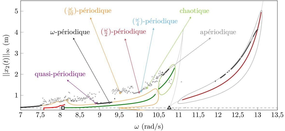
FIGURE V.18 – Validation des solutions de la DLFT-HBM pour  $A = 15$ , courbe de réponse principale (—), branches de solutions isolées (—) (—), NNM 1 (—), NNM 5 (—), NNM 6 (—), deux orbites périodiques persistent ( $\overline{\mathcal{M}}^{1:1} > 0$ ) (—), aucune orbite périodique ne persiste ( $\overline{\mathcal{M}}^{1:1} < 0$ ) (—),  $g_0$  (—), premier point singulier (■), second point singulier (▲), simulations IT  $\omega$ -périodiques (●), simulations IT pas  $\omega$ -périodiques (○).
