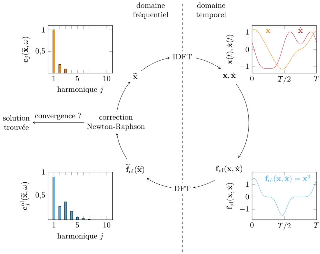
FIGURE II.2 – Procédure d'alternance fréquence/temps, adaptée de [206, 190],
