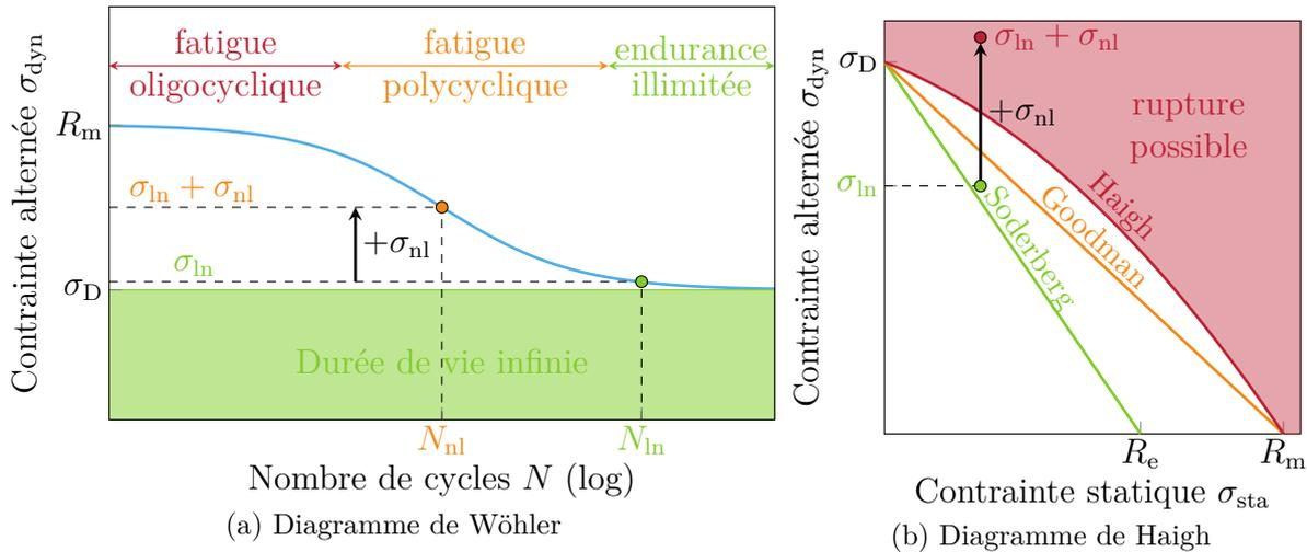
FIGURE I.4 – Outils de dimensionnement en fatigue vibratoire.
