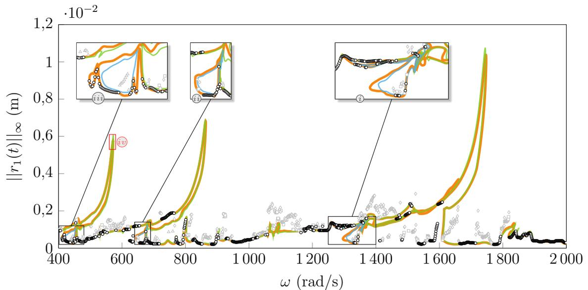
FIGURE IV.44 – Courbes de réponse en fréquence obtenues par les méthodes fréquentielles, DLFT-HBM (—), RL-HBM (—), branches de solutions isolées RL-HBM (—), IT de pulsation fondamentale  $\omega : \omega = 2\Omega$  (○),  $\omega = \Omega$  (△), sous-harmonique ( $\omega < \Omega$ ) (□), pas de périodicité ou  $\omega < \Omega/10$  (◇).
