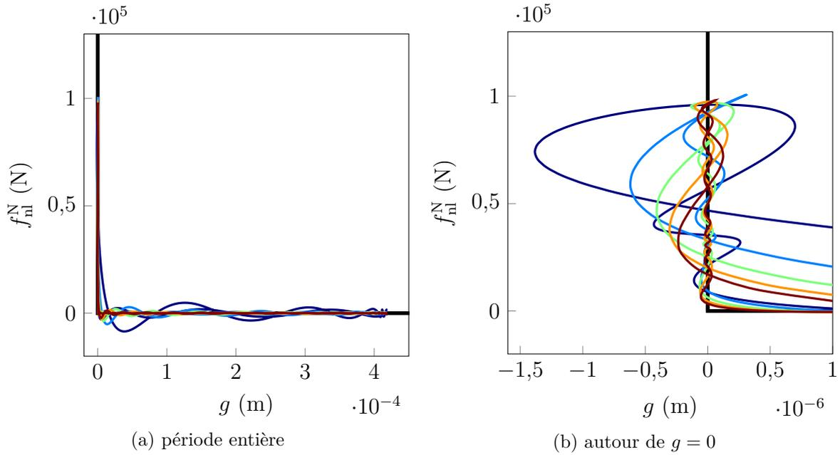
FIGURE IV.37 – Lois de contact simulées par la DLFT-HBM en fonction de  $N_h$  pour  $N_t = 400$  à  $\omega = \omega_1$ ,  $N_h = 10$  (—),  $N_h = 20$  (—),  $N_h = 30$  (—),  $N_h = 40$  (—),  $N_h = 50$  (—), contact unilatéral (—).
