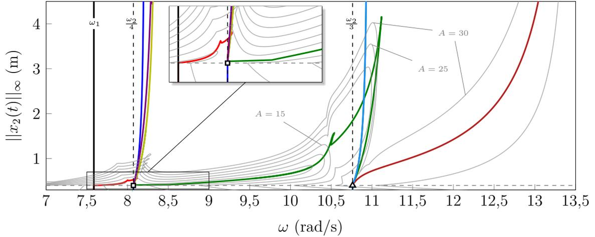
FIGURE V.6 – Analyse modale non linéaire de l'impacteur à deux degrés de liberté, courbes de réponse en fréquence  $A$  (—), NNM 1 (—), NNM 2 (—), NNM 3 (—), NNM 4 (—), NNM 5 (—), NNM 6 (—), NNM 7 (—),  $\omega_1$  (—), fractions de  $\omega_2$  (---),  $g_0$  (---), premier point singulier (□), second point singulier (Δ).
