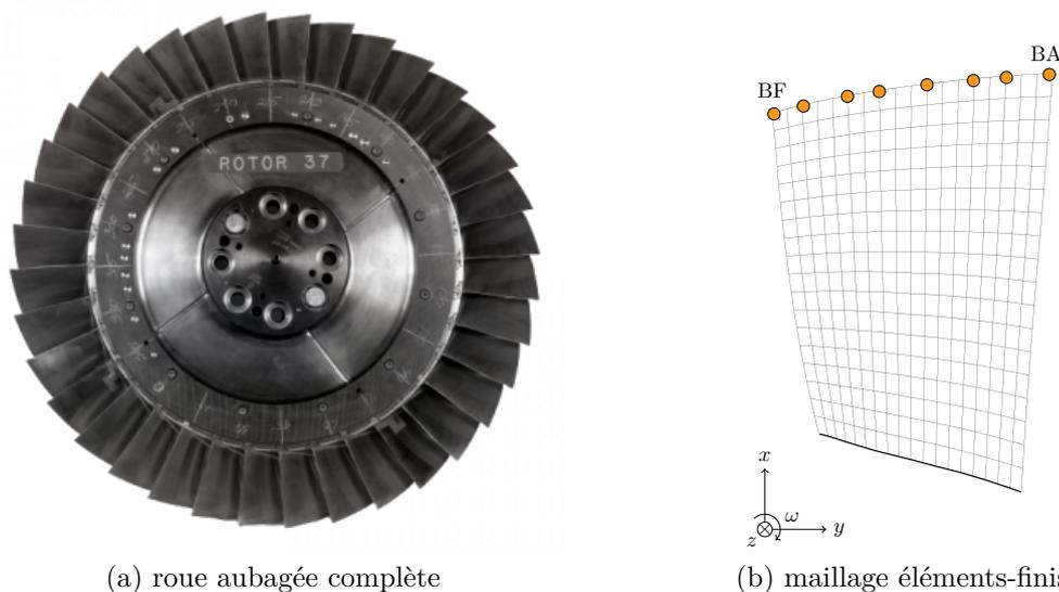
FIGURE V.28 – NASA rotor 37 [235], nœud frontière (●), encastrement (—)
