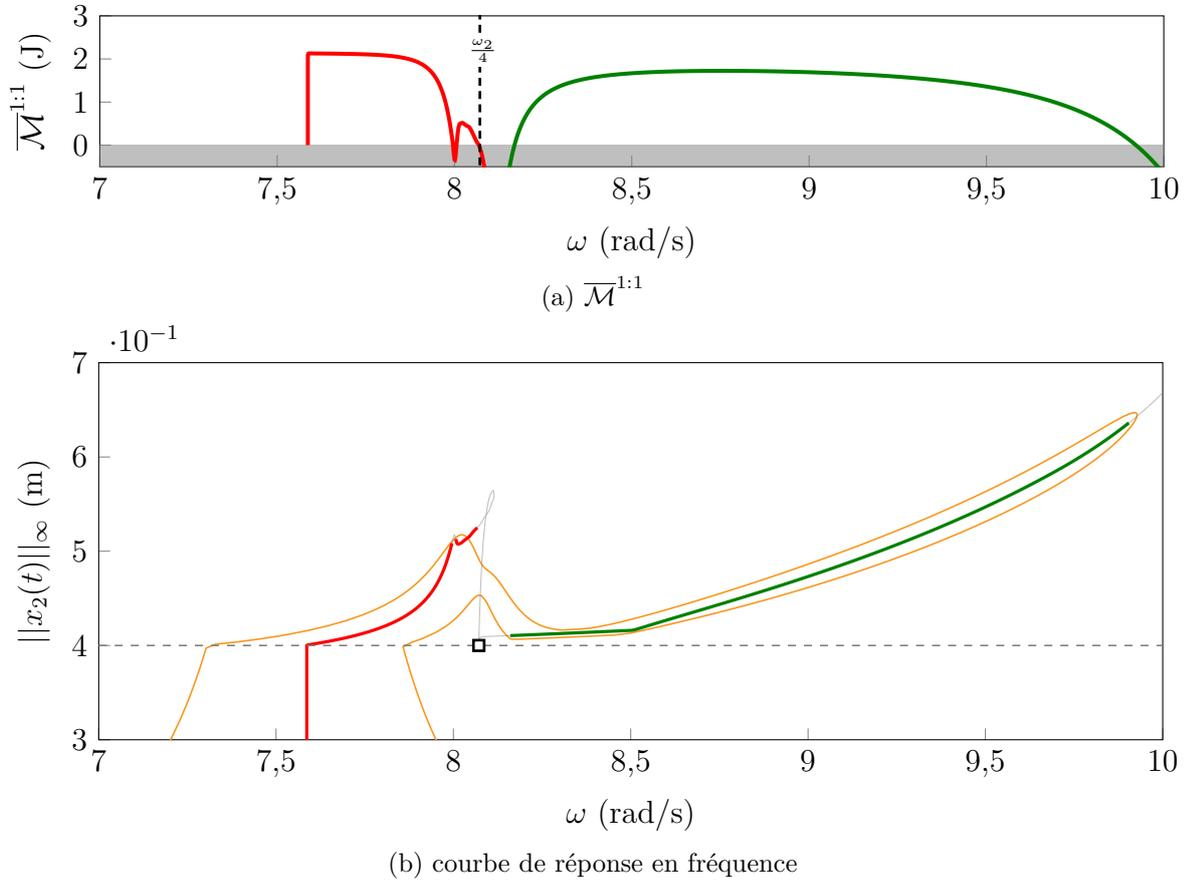
FIGURE V.11 – Analyse de Melnikov pour  $A = 2$ , NNM 1 (—), NNM 5 (—), courbe de réponse principale (—), deux orbites périodiques persistent ( $\overline{\mathcal{M}}^{1:1} > 0$ ) (—), aucune orbite périodique ne persiste ( $\overline{\mathcal{M}}^{1:1} < 0$ ) (—),  $g_0$  (—), premier point singulier (■).
