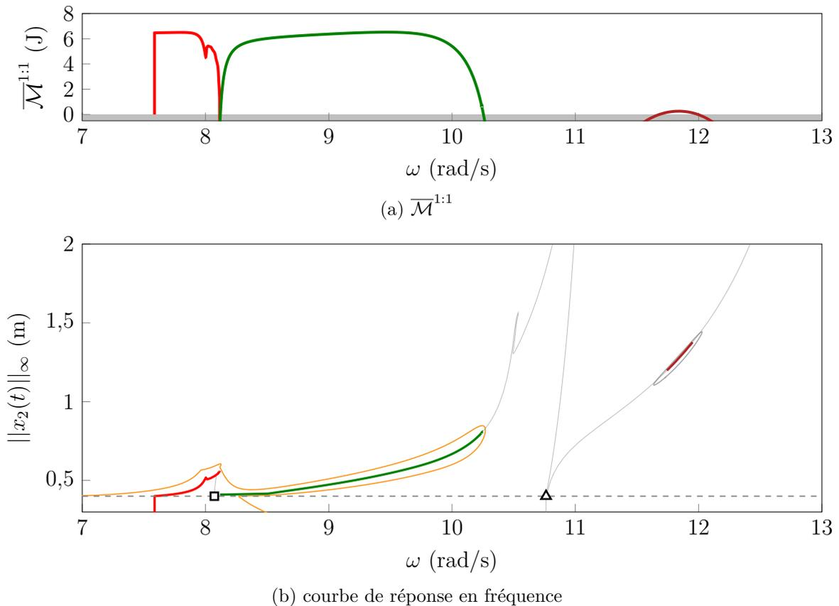
FIGURE V.14 – Analyse de Melnikov pour  $A = 5$ , NNM 1 (—), NNM 5 (—), NNM 6 (—), courbe de réponse principale (—), branche de solutions isolées (—), deux orbites périodiques persistent ( $\overline{\mathcal{M}}^{1:1} > 0$ ) (—), aucune orbite périodique ne persiste ( $\overline{\mathcal{M}}^{1:1} < 0$ ) (—),  $g_0$  (—), premier point singulier (■), second point singulier (▲).
