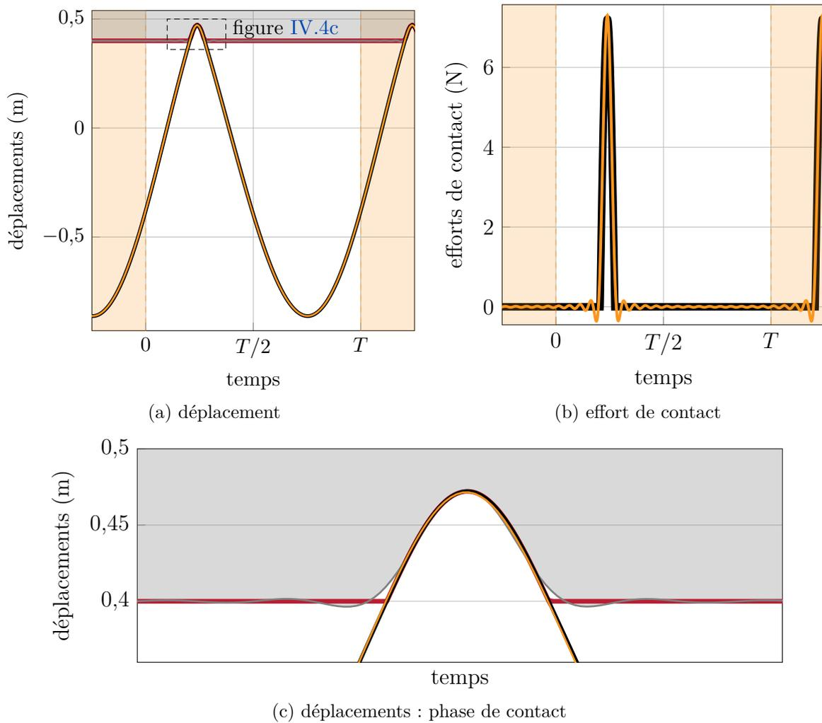
FIGURE IV.4 – Déplacements et efforts obtenus par la DLFT-HBM et IT à la résonance,  $x_1$  DLFT-HBM (—),  $x_1$  IT (—),  $x_2$  DLFT-HBM (■),  $x_2$  IT (—).
