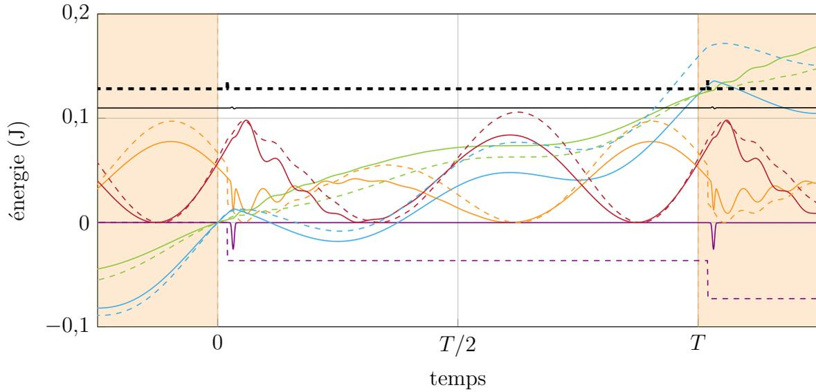
FIGURE IV.8 – Bilan énergétique sur une période pour  $m_2 = 2 \text{ kg}$  ( $N_t = 4000$ ), IT (---), DLFT-HBM (—), énergie totale (■), énergie cinétique (■), énergie potentielle (■), énergie dissipée (intégrale) (■), travail des efforts d'excitation (intégrale) (■), travail des efforts de contact (intégrale) (■).
