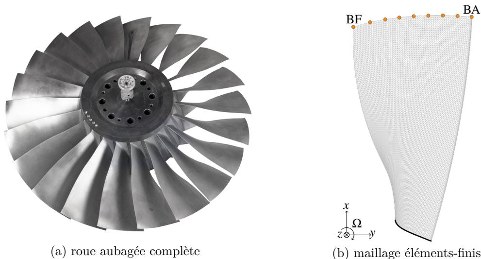
FIGURE IV.40 – NASA rotor 67 [237], nœud frontière (●), encastrement (—).
