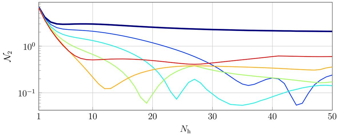
FIGURE IV.14 – Evolution de  $\mathcal{N}_2$  en fonction de  $N_h$  ( $N_t = 2000$  et  $m_2 = 2$  kg,  $\omega = 0,9 \text{ rad}\cdot\text{s}^{-1}$ ),  $n_{\text{dep}} = 0\%$  (DLFT-HBM classique) (—),  $n_{\text{dep}} = 1\%$  (—),  $n_{\text{dep}} = 2\%$  (—),  $n_{\text{dep}} = 3\%$  (—),  $n_{\text{dep}} = 4\%$  (—),  $n_{\text{dep}} = 5\%$  (—).
