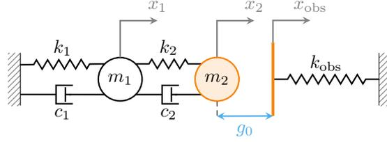
FIGURE V.2 – Modèle d'impacteur à deux degrés de liberté.
