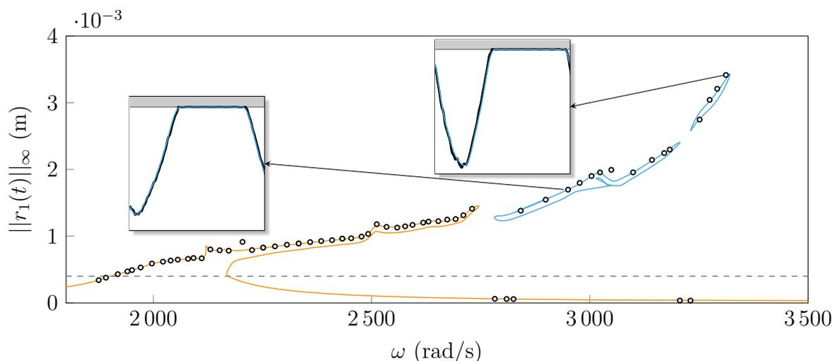
FIGURE V.40 – Validation des solutions de la DLFT-HBM par IT pour  $A = 140$ , courbe de réponse principale (—), branches de solutions isolées (—), IT ( $\circ$ ),  $c_1$  (- -). Graphes de déplacements : DLFT-HBM (—), IT (—), carter (■).
