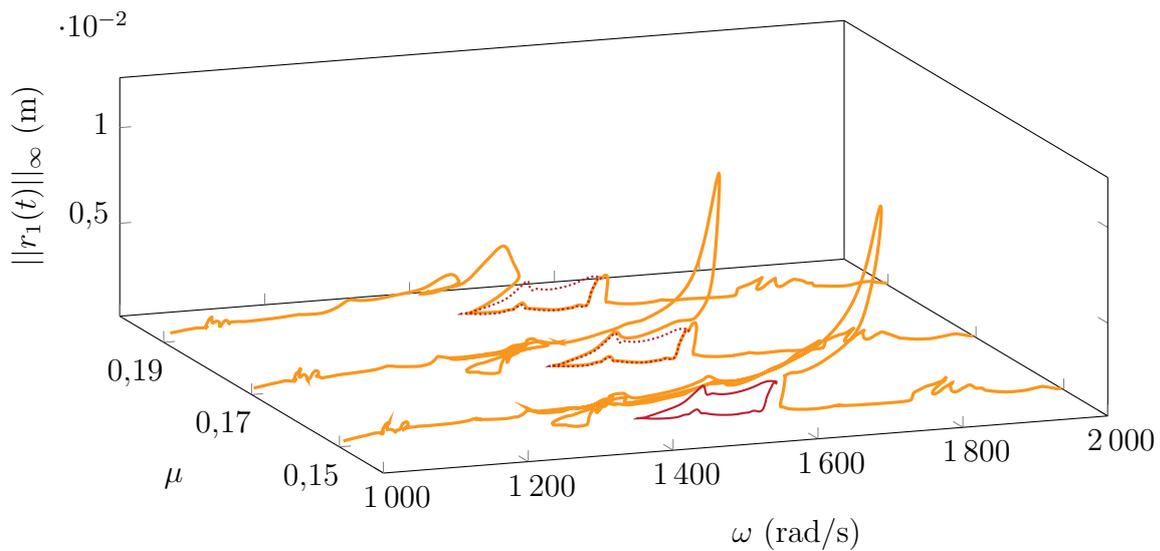
FIGURE IV.54 – Etude d'influence sur le coefficient de frottement  $\mu$ , courbe de réponse principale (—), isolat ① ( $\mu = 0,15$ ) ① (—), isolat ① projeté sur les plans  $\mu = 0,17$  et  $\mu = 0,19$  (.....).
