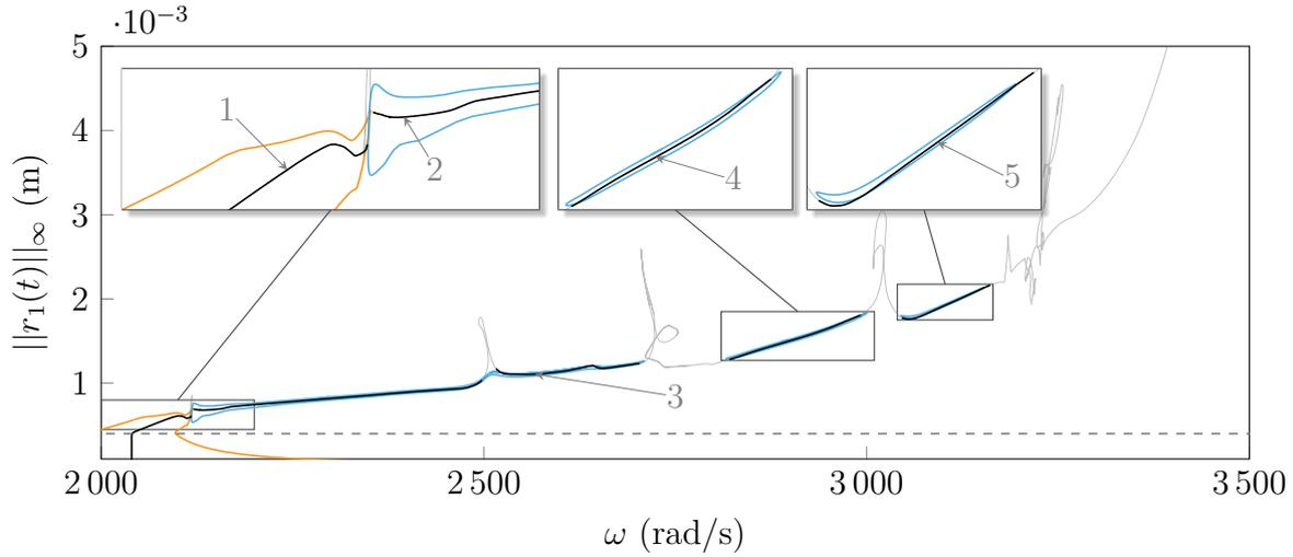
FIGURE V.42 – Application du principe énergétique de Melnikov pour  $A = 60$ , courbe de réponse principale (—), branches de solutions isolées (—), NNM 1F (—), deux orbites périodiques persistent ( $\overline{\mathcal{M}}^{1:1} > 0$ ) (—), aucune orbite périodique ne persiste ( $\overline{\mathcal{M}}^{1:1} < 0$ ) (—),  $c_1$  (- -).
