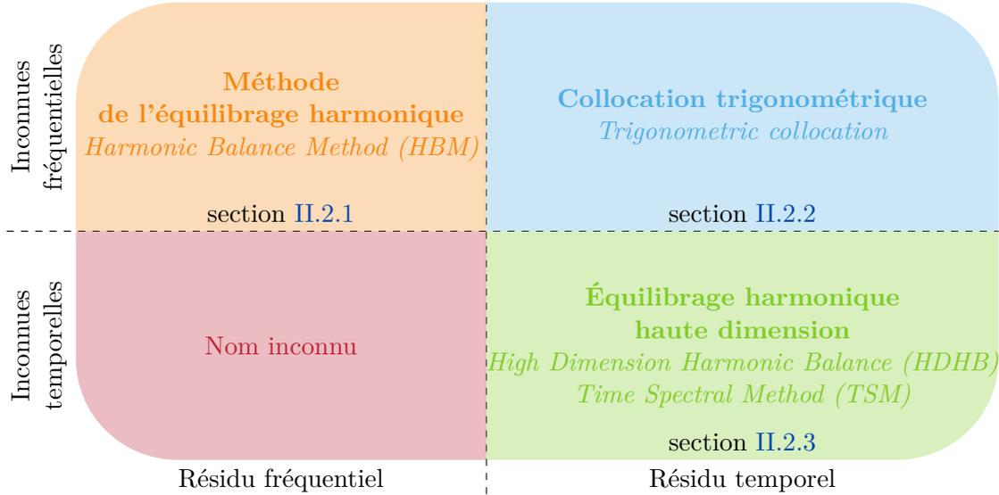
FIGURE II.3 – Positionnement des différentes méthodes fréquentielles, adaptée de [206, 190].
