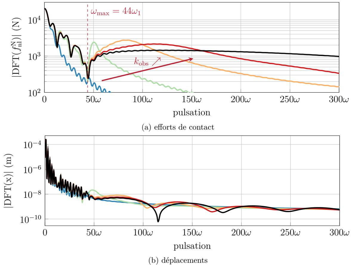
FIGURE IV.22 – Spectres des déplacements et efforts de contact pour différentes valeurs de  $k_{\text{obs}}$  à  $\omega = \omega_1$ , rigide (—),  $k_{\text{obs}} = 4k_{\text{bar}}$  (—),  $k_{\text{obs}} = 40k_{\text{bar}}$  (—),  $k_{\text{obs}} = 200k_{\text{bar}}$  (—),  $k_{\text{obs}} = 400k_{\text{bar}}$  (—).
