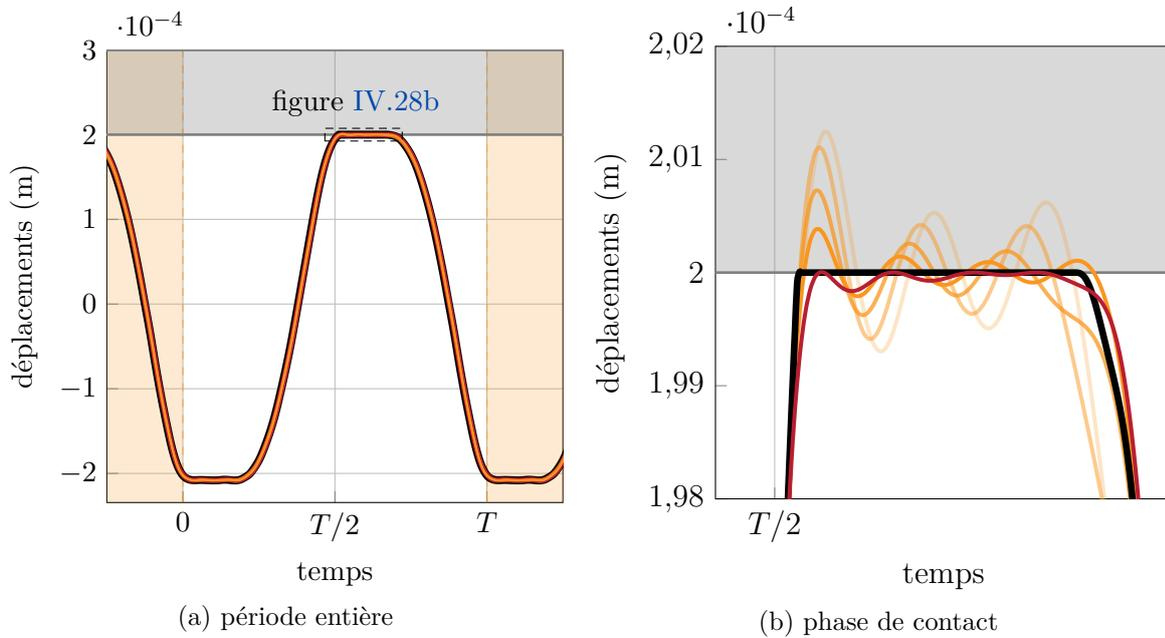
FIGURE IV.28 – Déplacement du nœud de contact en fonction de  $\varepsilon$  pour  $N_h = 20$  et  $N_t = 400$ , IT (Lagrange) (—), DLFT-HBM  $\varepsilon = 1 \cdot 10^8 \text{ N}\cdot\text{m}^{-1}$  (—), DLFT-HBM  $\varepsilon = 1 \cdot 10^9 \text{ N}\cdot\text{m}^{-1}$  (—), DLFT-HBM  $\varepsilon = 1 \cdot 10^{10} \text{ N}\cdot\text{m}^{-1}$  (—), DLFT-HBM  $\varepsilon = 1 \cdot 10^{11} \text{ N}\cdot\text{m}^{-1}$  (—), LCP-HBM (—), obstacle rigide (■).
