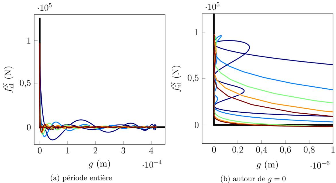
FIGURE IV.38 – Lois de contact simulées par la LCP-HBM en fonction de  $N_h$  pour  $N_t = 400$  à  $\omega = \omega_1$ ,  $N_h = 10$  (—),  $N_h = 20$  (—),  $N_h = 30$  (—),  $N_h = 40$  (—),  $N_h = 50$  (—), contact unilatéral (—).
