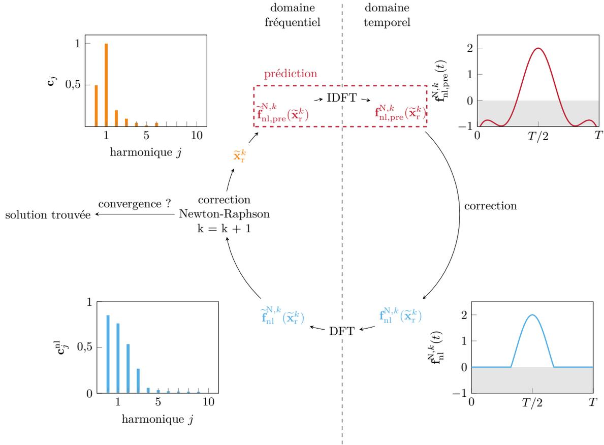
FIGURE III.4 – Procédure DLFT-HBM,  $c_j^\bullet = \sqrt{(a_j^\bullet)^2 + (b_j^\bullet)^2}$ .
