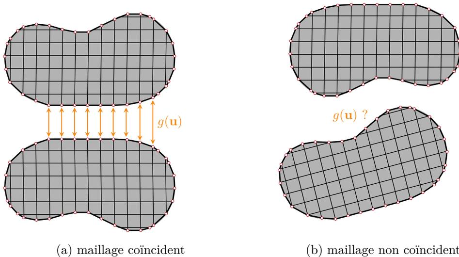
FIGURE I.12 – Définition du jeu entre deux structures flexibles.
