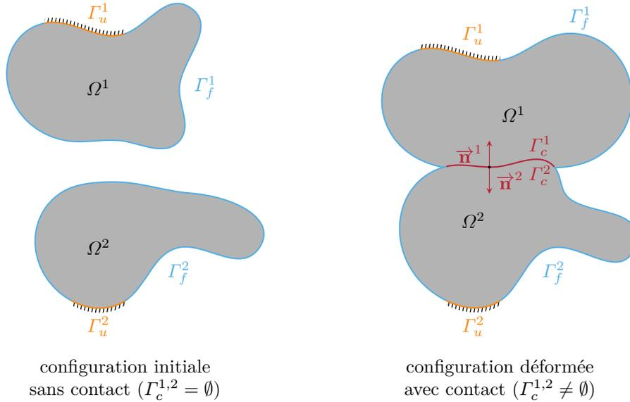
FIGURE I.6 – Deux corps élastiques en contact.
