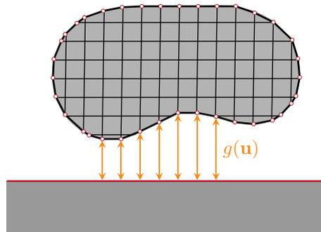
FIGURE I.11 – Solide en contact avec un obstacle rigide.
