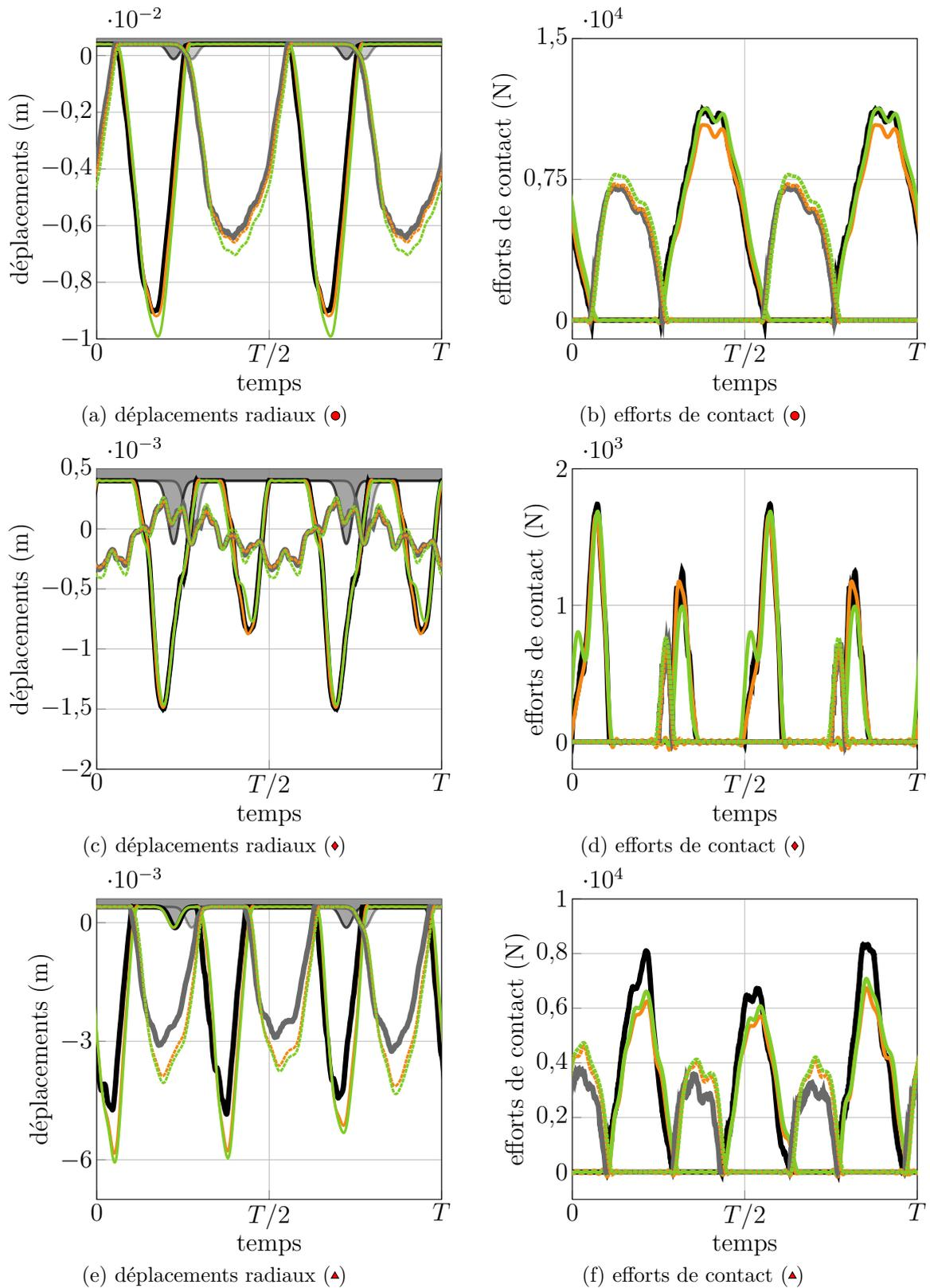
FIGURE IV.48 – Signaux temporels de déplacements radiaux et d'efforts de contact à la résonance principale ( $\bullet$ ), sur l'isolat ① ( $\blacklozenge$ ) et la branche ③ ( $\blacktriangle$ ), DLFT-HBM : BA (—) BF (—), RL-HBM : BA (—) BF (—), IT : BA (—) BF (—).
