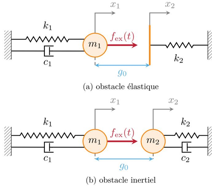
FIGURE IV.1 – Impacteur à un degré de liberté en configuration de vibro-impact.
