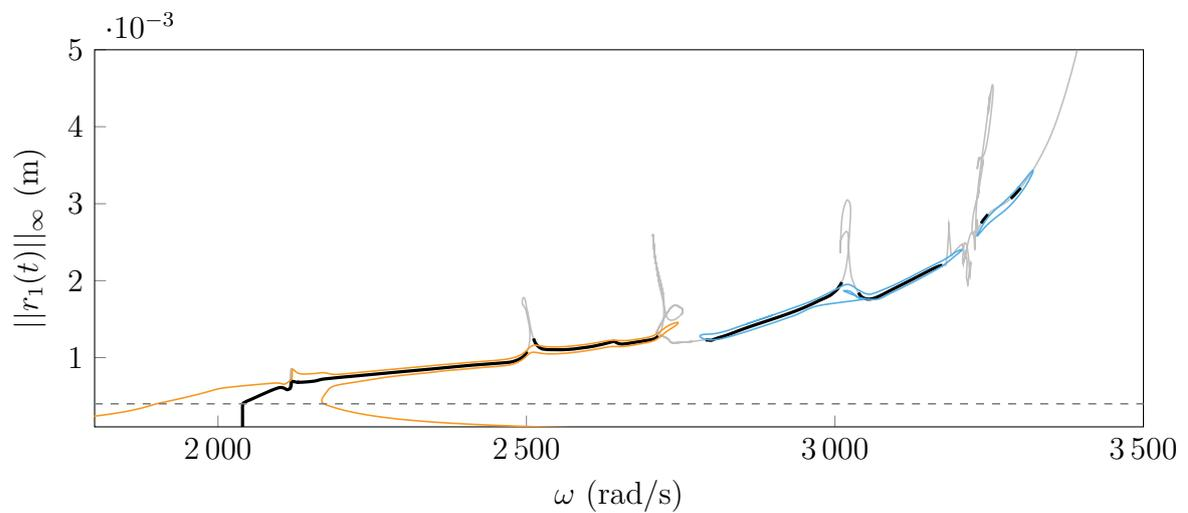
FIGURE V.39 – Réponse en fréquence du rotor 67 pour  $A = 140$ , courbe de réponse principale (—), branches de solutions isolées (—), NNM 1F (—), deux orbites périodiques persistantes ( $\overline{\mathcal{M}}^{1:1} > 0$ ) (—), aucune orbite périodique ne persiste ( $\overline{\mathcal{M}}^{1:1} < 0$ ) (—),  $c_1$  (- -).
