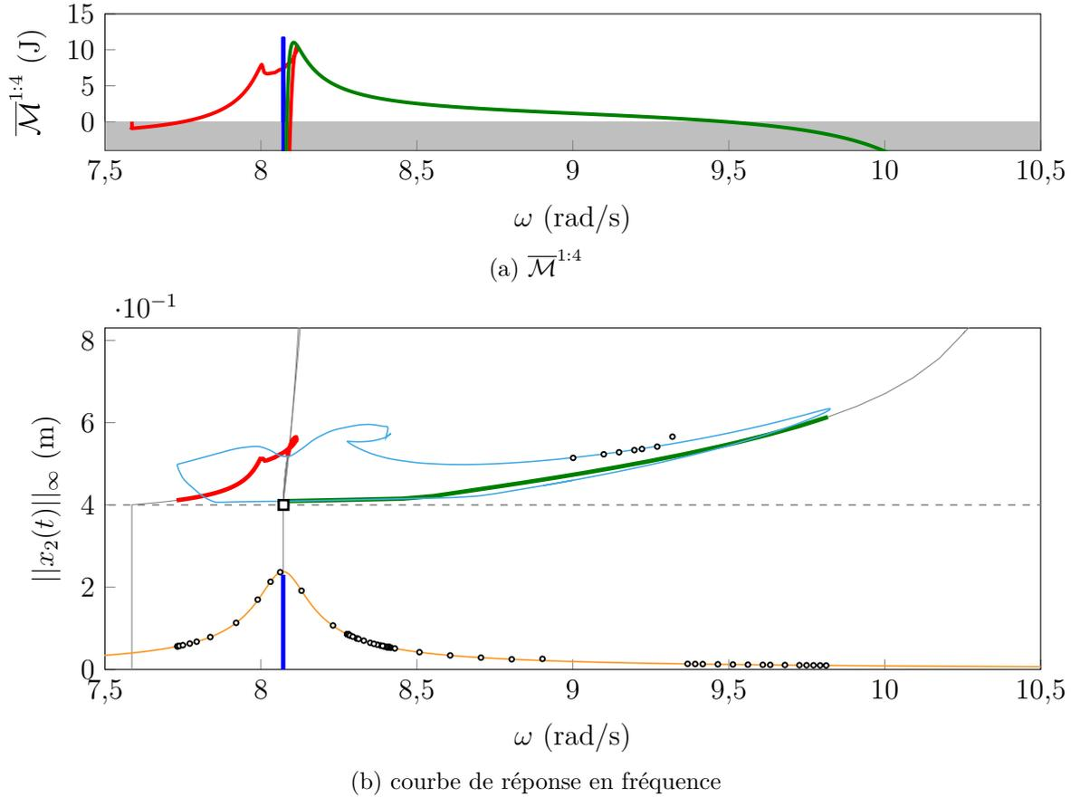
FIGURE V.23 – Analyse de Melnikov pour une excitation du deuxième mode sur le quatrième harmonique avec  $A = 10$ , NNM 1 (—), NNM 2 (—), NNM 5 (—), courbe de réponse principale (—), branche de solutions isolées (—), deux orbites périodiques persistent ( $\overline{\mathcal{M}}^{1:4} > 0$ ) (—), aucune orbite périodique ne persiste ( $\overline{\mathcal{M}}^{1:4} < 0$ ) (—),  $g_0$  (—), premier point singulier (■), simulations IT (○).
