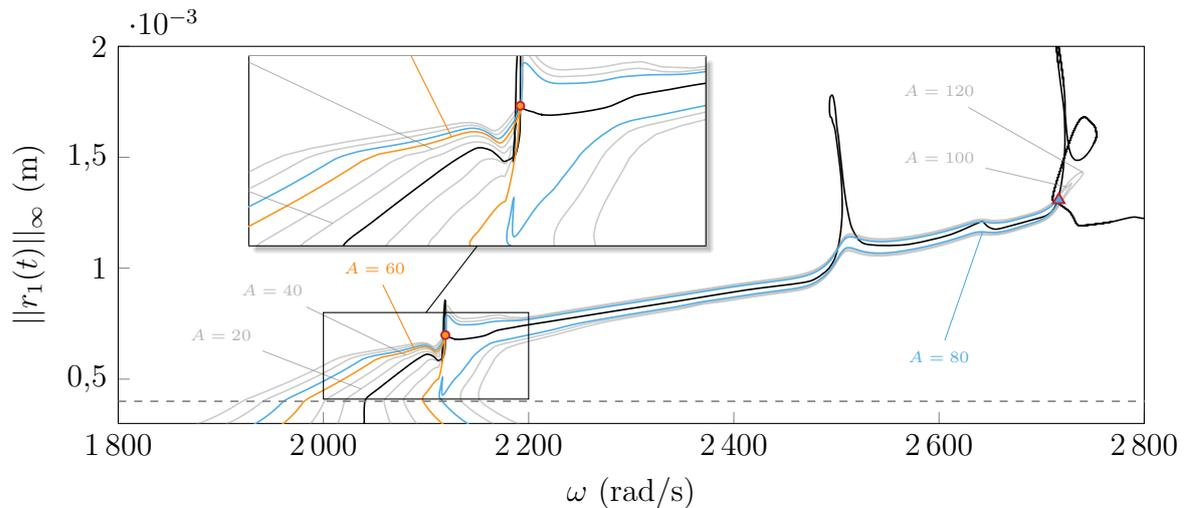
FIGURE V.41 – Courbes de réponse principales de  $A = 20$  à  $A = 120$  pour le rotor 67,  $A = 60$  (—),  $A = 80$  (—),  $A \in \{20; 40; 100; 120\}$  (—), NNM (—), résonance pour  $A = 60$  (●), résonance pour  $A = 80$  (▲),  $c_1$  (- -).
