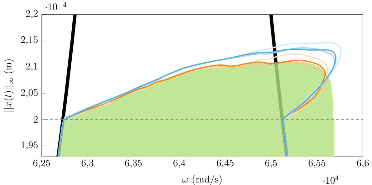
FIGURE IV.30 – Courbes de réponse en fréquence pour les configurations rigide et flexible ( $k_{\text{obs}} = 40k_{\text{bar}}$ )  $N_t = 400$  et  $N_h$  variable, linéaire (—),  $g_0$  (- -), IT balayage linéaire (obstacle rigide) (■), DLFT-HBM obstacle flexible :  $N_h = 20$  (—),  $N_h = 30$  (—),  $N_h = 40$  (—), DLFT-HBM obstacle rigide :  $N_h = 20$  (—),  $N_h = 30$  (—),  $N_h = 40$  (—).
