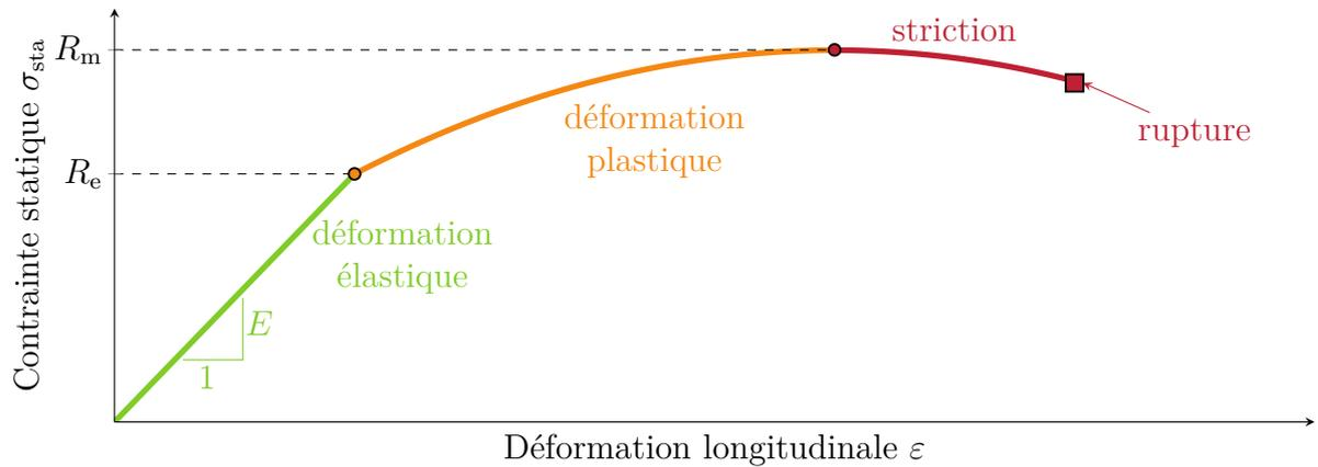
FIGURE I.3 – Loi de comportement en traction-compression.
