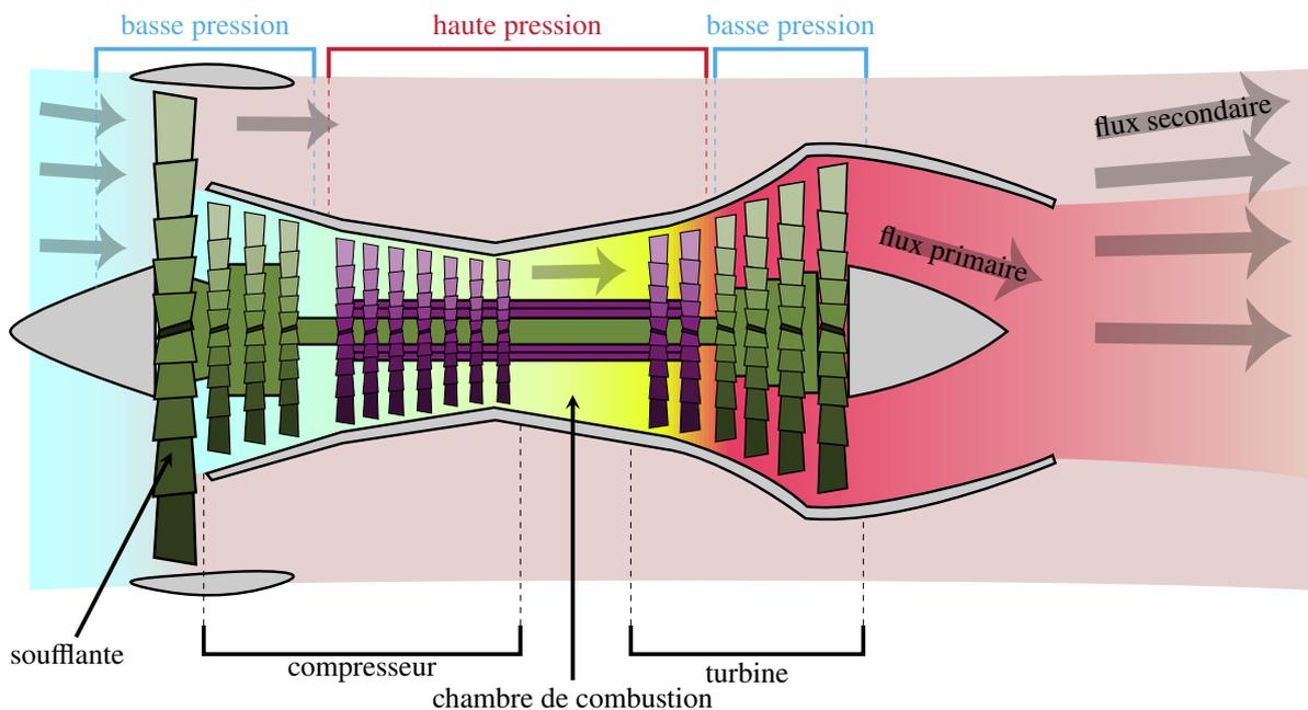
FIGURE I.2 – Vue schématique d'une turbomachine aéronautique double corps et double flux<sup>3</sup>.
