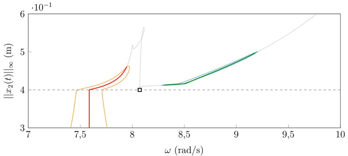
FIGURE V.9 – Analyse de Melnikov pour  $A = 1$ , NNM 1 (—), NNM 5 (—), courbe de réponse principale (—), branche de solutions isolées (—), deux orbites périodiques persistent ( $\overline{\mathcal{M}}^{1:1} > 0$ ) (—), aucune orbite périodique ne persiste ( $\overline{\mathcal{M}}^{1:1} < 0$ ) (—),  $g_0$  (—), premier point singulier (■).
