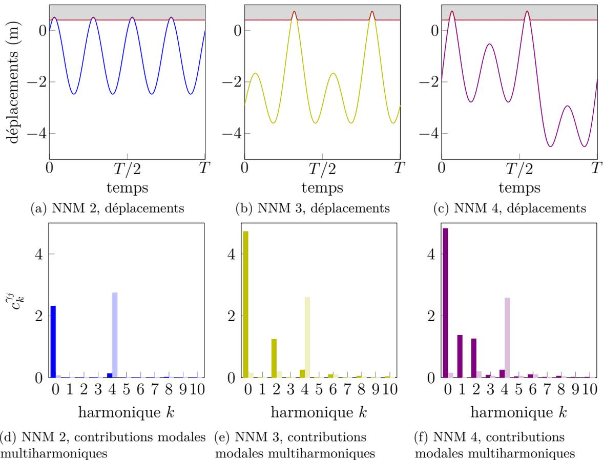
FIGURE V.8 – Comparaison des solutions à une énergie totale  $E_{\text{tot}} = 1 \text{ J}$  pour les NNM 2, 3 et 4,  $x_2(t)$  (—) (—) (—), obstacle (□), première forme modale ( $j = 1$ ) (■) (■) (■), seconde forme modale ( $j = 2$ ) (■) (■) (■).
