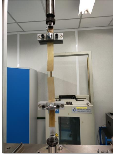
Figure 59 - Machine de traction avec une bandelette de papier après essai
