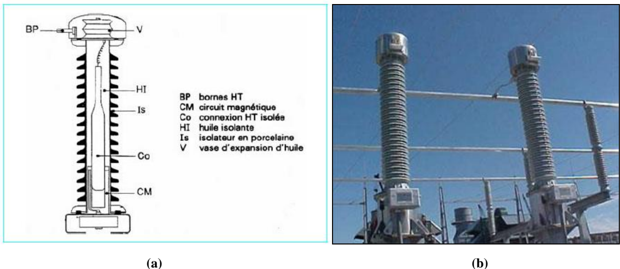
Figure 4 - Schéma (a) [6] et photo (b) d'un transformateur de tension inductif
