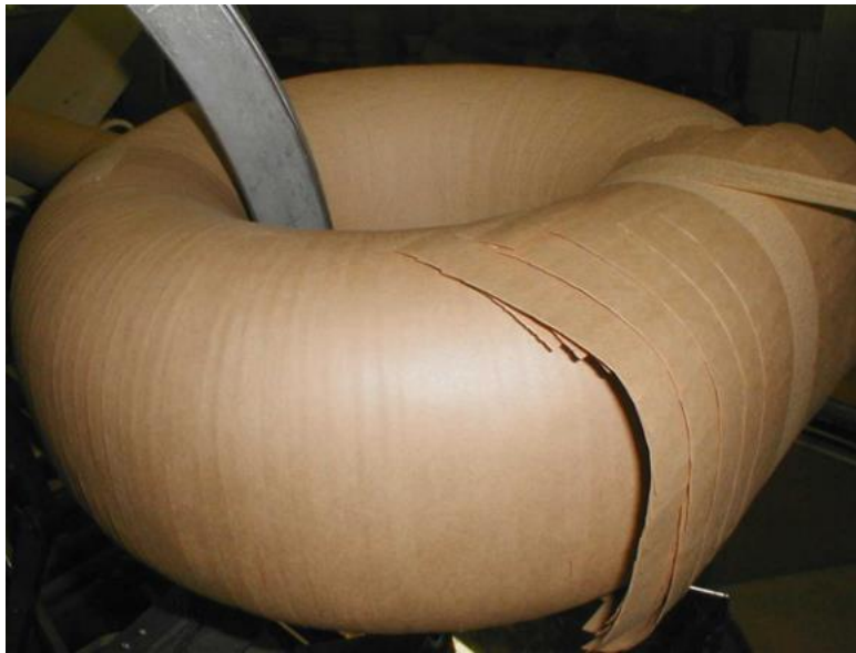
Figure 9 - Isolation cellulosique autour du noyau magnétique d'un TC
