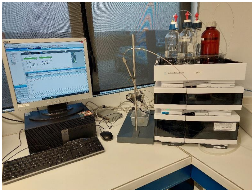
Figure 114 - Appareil d'analyse en HPLC pour les dérivés furaniques
