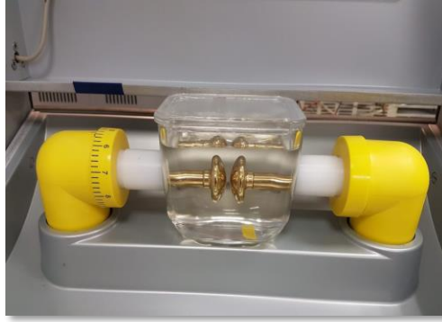
Figure 61 - Banc de claquage pour la mesure de la tension de claquage
