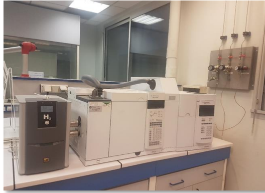
Figure 66 - Appareil de chromatographie phase gazeuse avec système d'extraction Headspace pour l'analyse des gaz dissous
