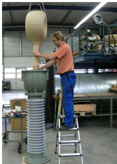
Figure 13 - Montage de la partie active entourée de papier isolant avant séchage
