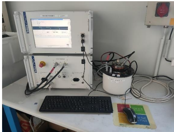
Figure 64 - Appareil de mesure du facteur de dissipation diélectrique
