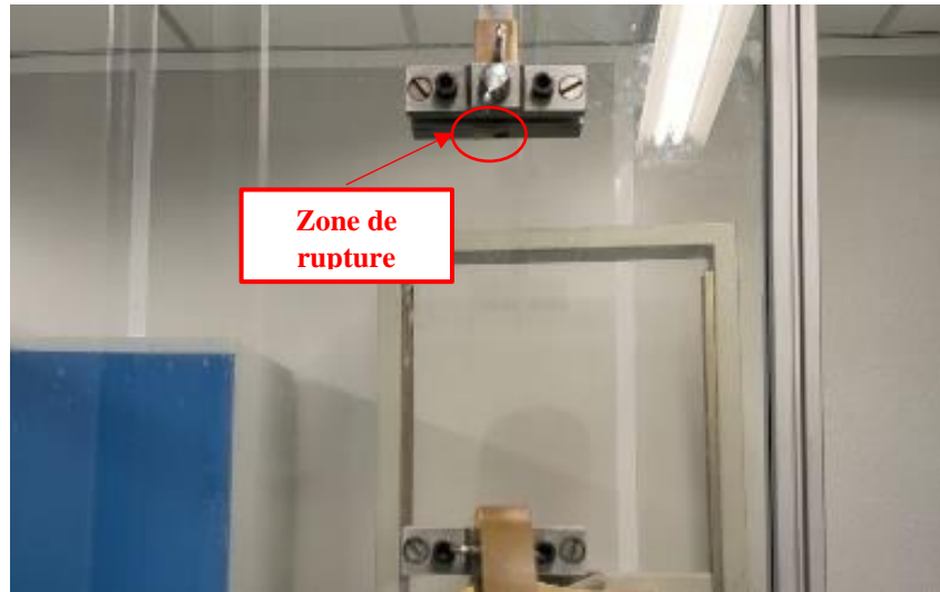
Figure 60 - Essai de traction sur bandelette vieillie où la zone de rupture se situe au niveau des mors
