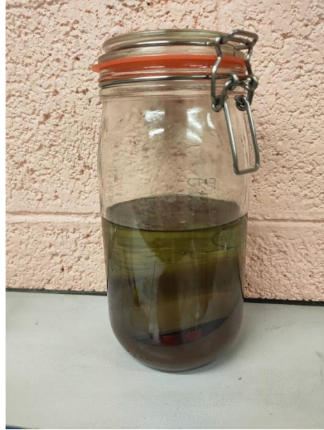
Figure 58 - Bocal en verre scellé sous vide contenant le papier, l'huile et le cuivre
