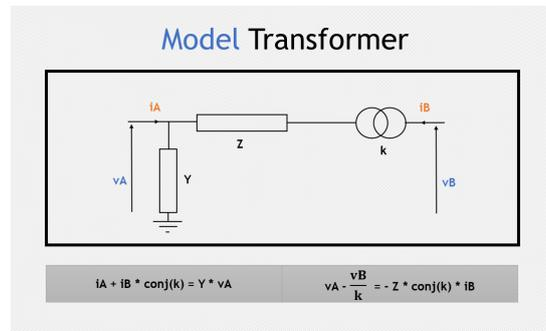
FIGURE 2.16 – Modèle des transformateur (documentation dans PowerSysPro [3])
