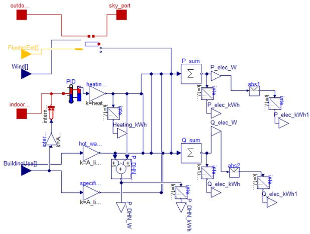
FIGURE 4.6 – Modèle complet du système énergétique
