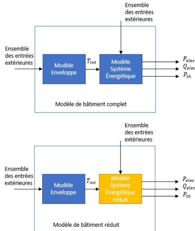
FIGURE 4.9 – Remplacement d’un modèle complet par un modèle réduit
