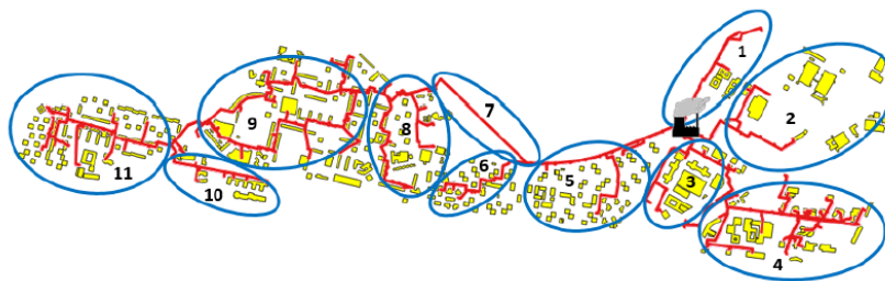
FIGURE 2.7 – 11 sous-réseaux du réseau de chaleur [2]
