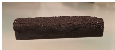
FIGURE 3.4 – Plaque de plexiglass rugosifiée en surface et fixée sur la face supérieure du capteur de force, évitant le glissement de la racine.
