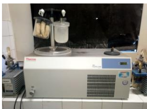
Figure 52: Lyophilisation des pelures et de pulpes à gauche et pulpes caramélisées à droite
