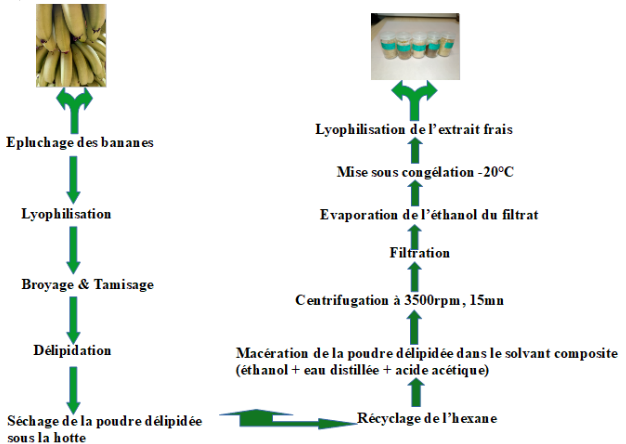
Figure 60: Diagramme d'extraction des extraits bruts
