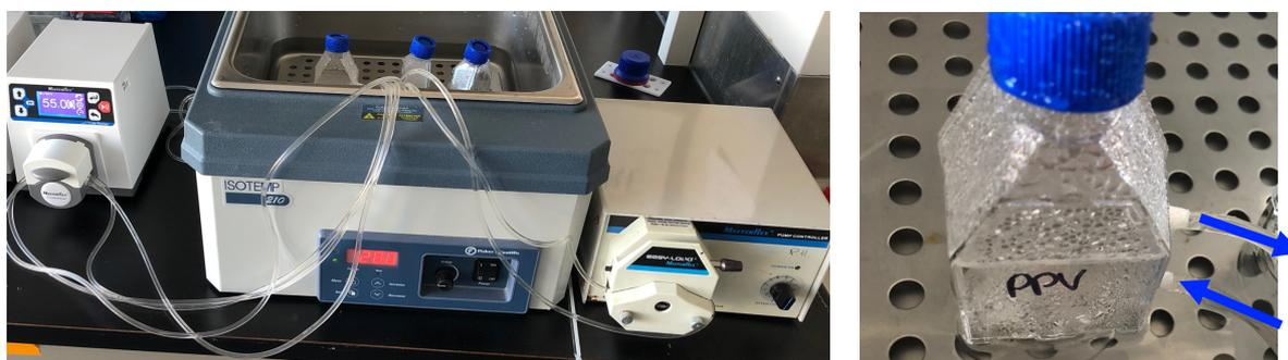
**Figure 5.15.** Photos du système d'incubation avec remise en suspension des MP crémés par aspiration au niveau de l'interface air/liquide et relargage à environ 1 cm du fond du flacon. Le bain thermostaté permet de maintenir la température à 28°C.
