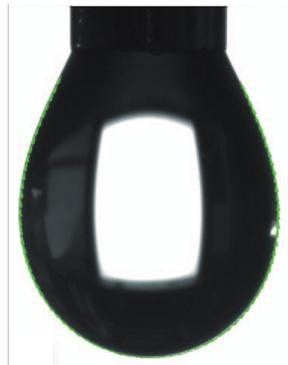
**Figure 2.7.** Image d'une goutte pendante permettant la détermination de la tension superficielle d'un liquide dans l'air (adapté de <sup>13</sup>).
