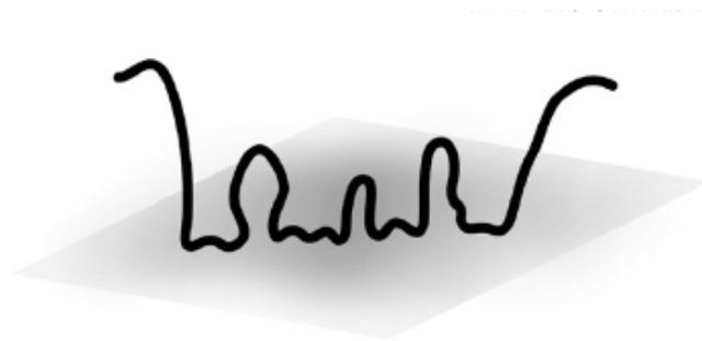
**Figure 1.11.** Représentation schématique d'un polymère adsorbé sur une surface par différents points d'ancrage.<sup>110</sup>
