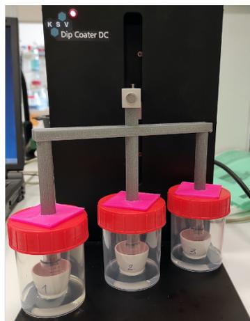
**Figure 2.11.** Système de dip-coating permettant de réaliser trois expériences simultanées à fort taux d'humidité (les flacons contiennent 10 mL d'eau). Dispositif mis au point par Florent Saudrais.
