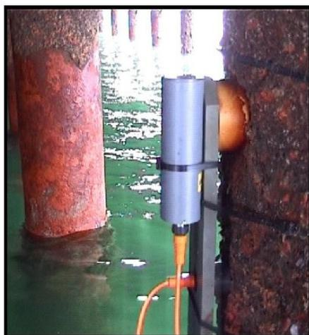
*figure 78 : suivi de biocorrosion par le système CABAS dans le port de Brest, France*
