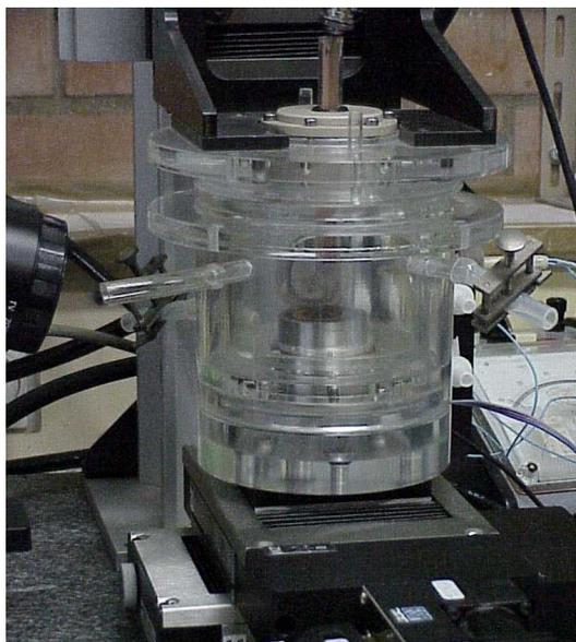
figure 85 : cellule de biocorrosion montée sur table X-Y-Z
