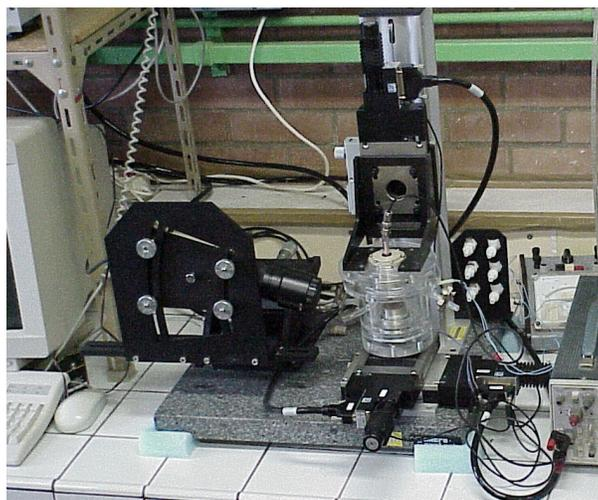
figure 82 : montage expérimental pour la réalisation de cartographies de densité de courant
