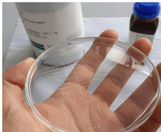
Figure III-5 - Boîte de pétri contenant du PDMS. Il est découpé en morceaux de taille adaptée pour réaliser des transferts sur substrat.
