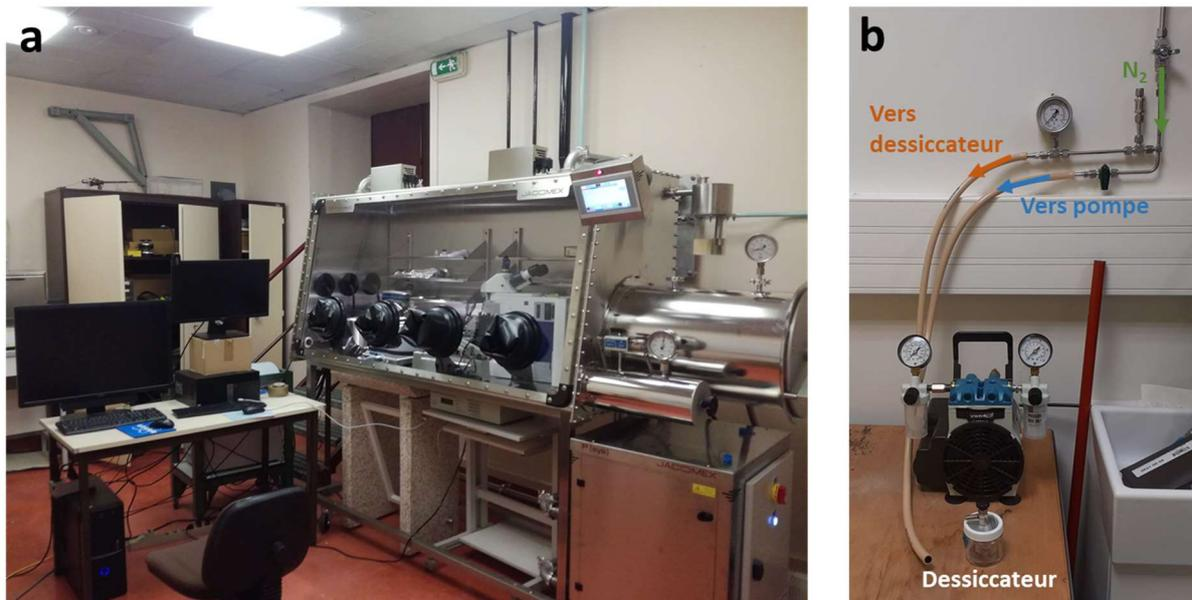
Figure III-3 - (a) Boîte à gants installée avant ma thèse au LEM. (b) Système de mise sous atmosphère azote, installé durant la thèse au GEMaC.
