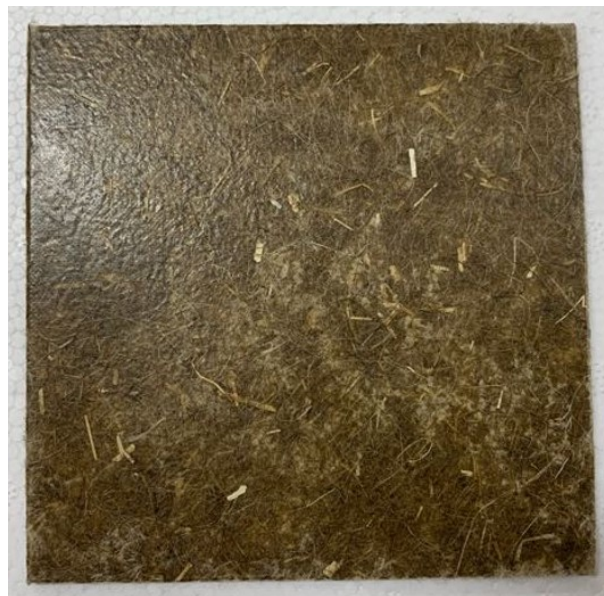
FIGURE 3.16 – Composites 100 % biosourcés imprégnés en voie sèche.
