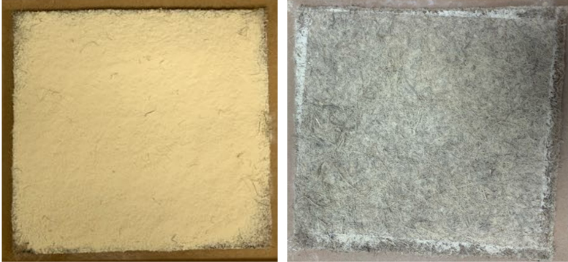
FIGURE 3.15 – Imprégnation d'un mat de lin. À gauche : poudre tamisée à 100 \mu\text{m} déposée à la surface du mat. À droite : résultat après application du champ électrique ; la poudre a pénétré le réseau de fibre.
