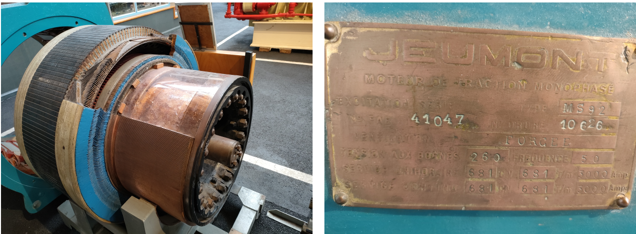
FIGURE 1.4 – Photographie du rotor d'un moteur à courant continu (1954) et de sa plaque signalétique
