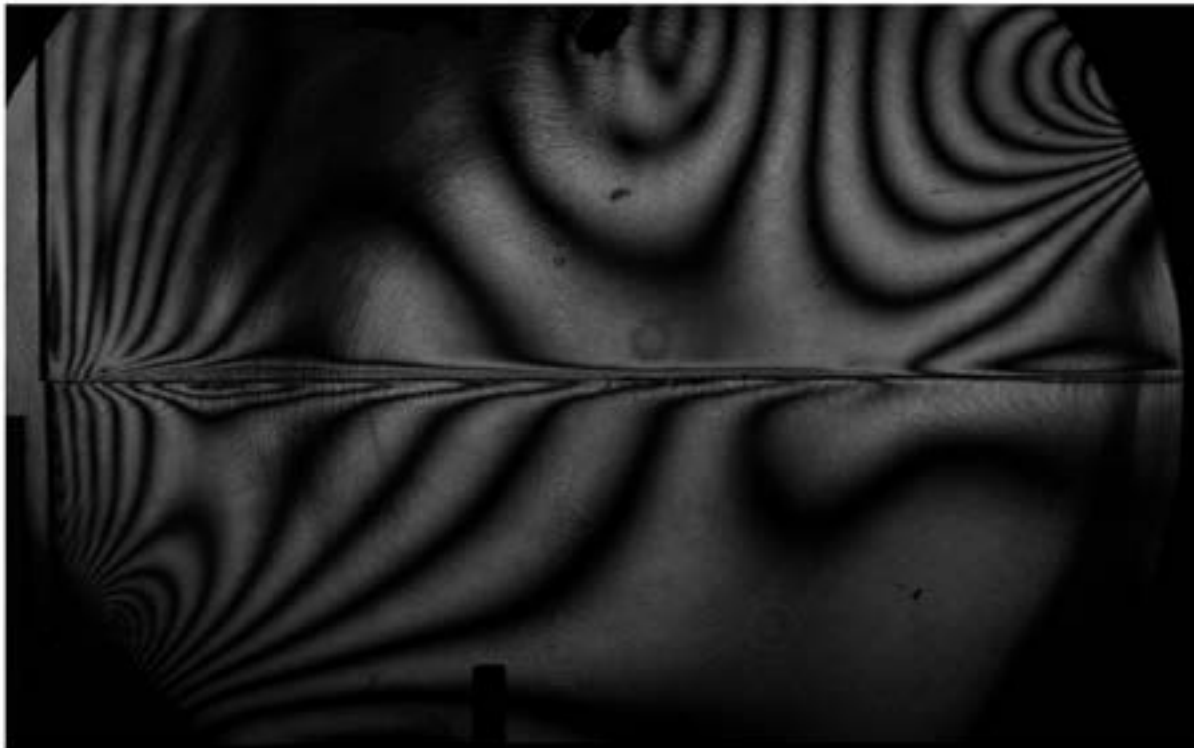
FIGURE 2.4 – Exemple de franges d'interférence lorsque les plaques de polycarbonate sont mises sous contrainte.
