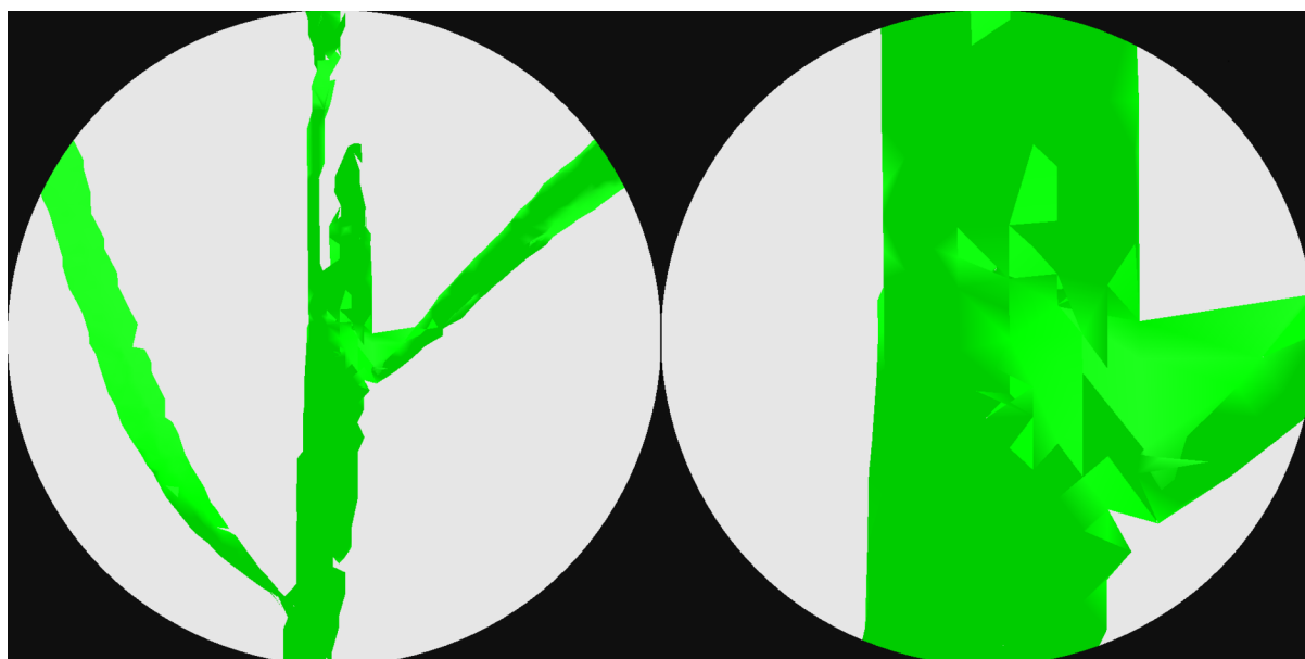
Figure 59: Exemple de mesures effectuées à l'aide du capteur SVC. À gauche le nombre de pixels de plante dans la zone du capteur est de 5 % et de 20 % sur la figure de droite.
