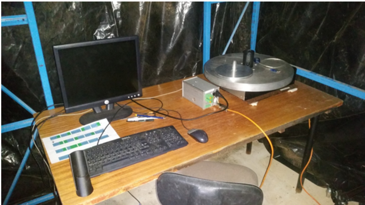
Figure 32: Table rotative et ordinateur permettant de faire les acquisitions 3D.
