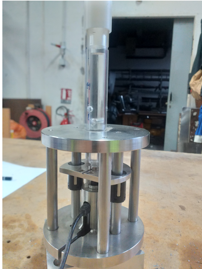
Figure 2.6 – La dernière version de la presse a été usinée et possède plus de colonnes de guidages. La presse est ainsi plus rigide. Le poids supplémentaire du plateau de chargement que devra reprendre le moteur a été calculé pour ne pas être rédhibitoire. Il est aussi prévu de rajouter un capteur de déplacement laser pour une mesure plus précise.
