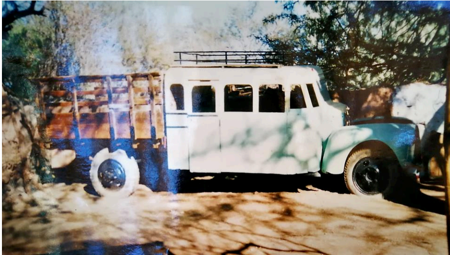
Image 48. Bus-camion mixte à San Pedro de Atacama, dans les années 1980. La partie arrière en bois, pour le transport des animaux; la carrosserie intermédiaire, pouvant accueillir douze passagers.
