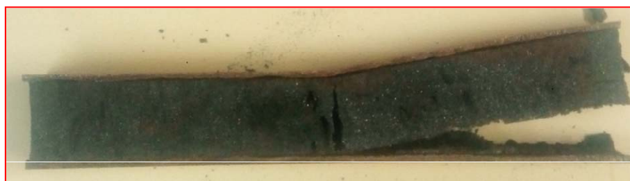
Figure V.19: 3 ème mode d'endommagement, relevé pour les poutres sandwichs à épaisseur d'âme e_a = 40 mm.
