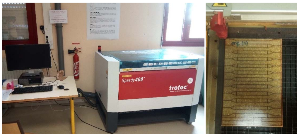
Figure II.5 : Machine de découpe laser Trotec et aperçu de la découpe des éprouvettes dans une plaque composite.
