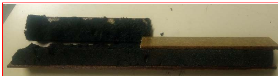
Figure V.17: 1 er mode d'endommagement, relevé pour les poutres sandwichs à épaisseur d'âme e_a = 20 mm.
