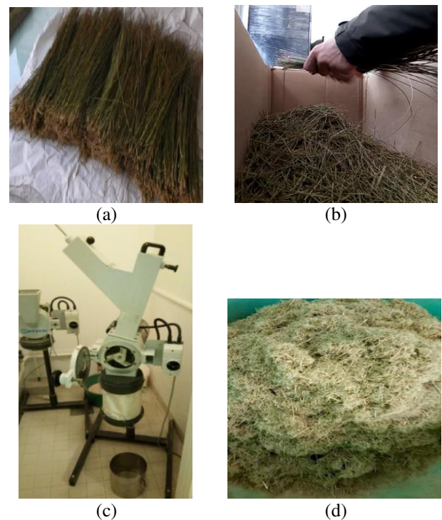
Figure 1. Procédure de préparation des fibres courtes - (a) Tiges d'Alfa, (b) Découpage, (c) Broyeur, (d) Fibres courtes broyées
