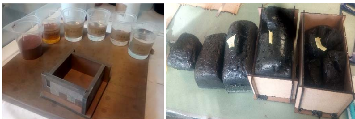
Figure IV.9 : Préparation des dosages de la mousse et résultats des produits obtenus.
