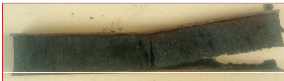
Figure V.19: 3<sup>ème</sup> mode d'endommagement, relevé pour les poutres sandwichs à épaisseur d'âme  $e_a = 40$  mm.
