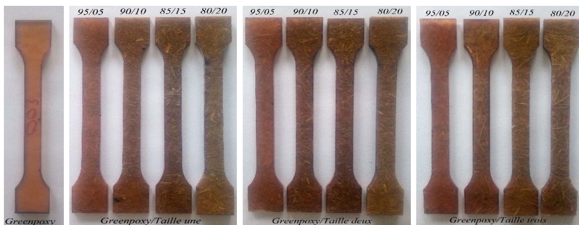
Figure II.8 : Vue générale des éprouvettes de traction pour les différents taux et tailles de fibres.
