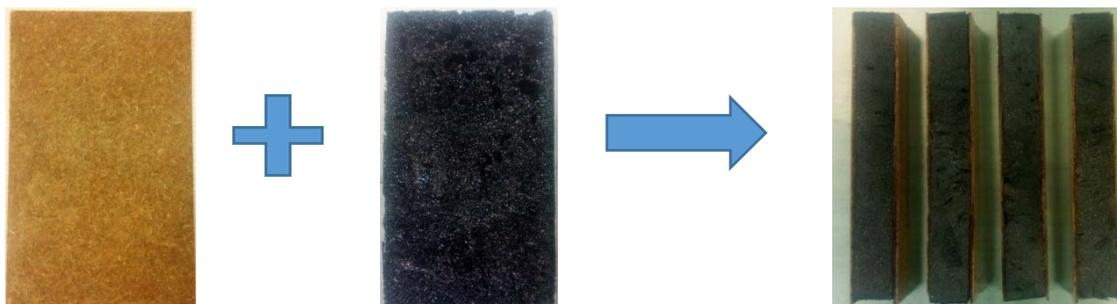
*Composite biosourcé**Mousse**Panneaux sandwich**Figure V.5 : Constituants d'un panneau sandwich.*
