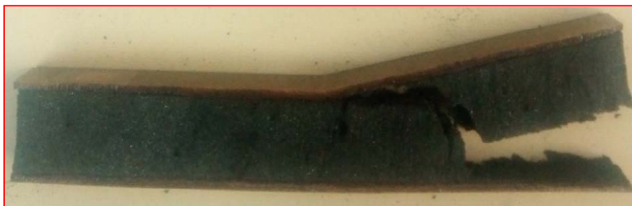
Figure V.18: 2 ème mode d'endommagement, relevé pour les poutres sandwichs à épaisseur d'âme e_a = 40 mm.
