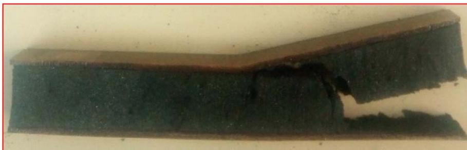
Figure V.18: 2<sup>ème</sup> mode d'endommagement, relevé pour les poutres sandwichs à épaisseur d'âme  $e_a = 40$  mm.
