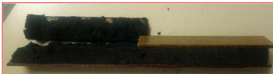
Figure V.17: 1<sup>er</sup> mode d'endommagement, relevé pour les poutres sandwichs à épaisseur d'âme  $e_a = 20$  mm.
