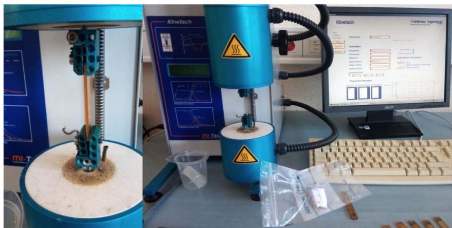
Figure II.13 : Machine DMTA Kinetech de mesure de transition vitreuse
