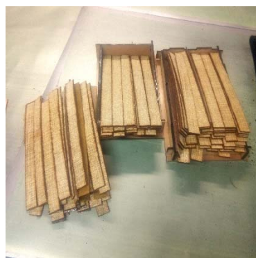
d) Lamelles en composite biosourcé
