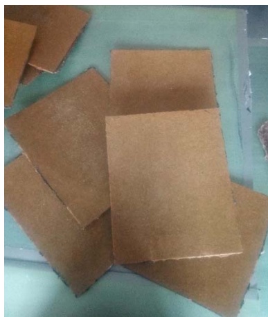
a) Plaques en composite biosourcé
