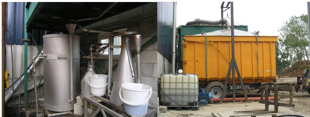
Figure 26: Pilote d'extraction des huiles essentielles ; à gauche le réfrigérant et l'essencier pour récupérer les HE, à droite la remorque permettant la distillation de la biomasse.
