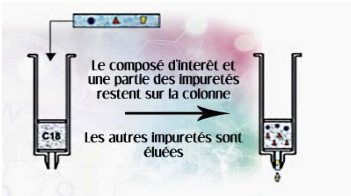
Figure II- 11 : Percolation de l'échantillon
