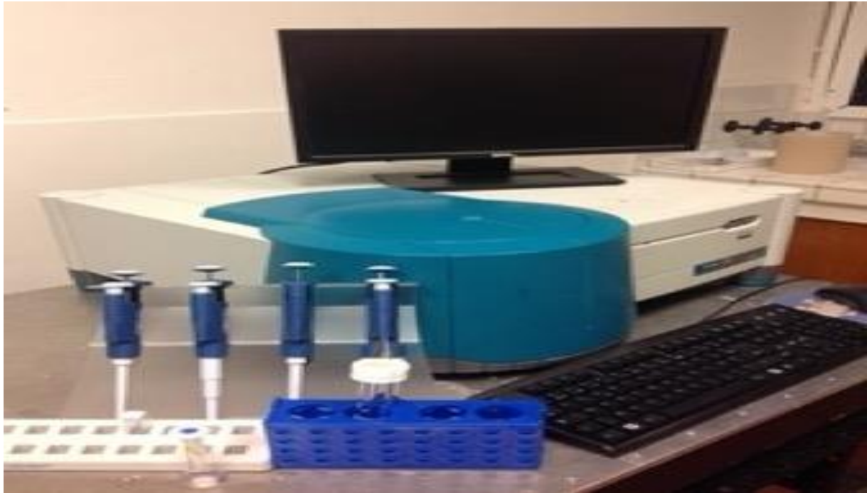
Figure II- 5 : L'appareil du spectrofluorimètre (Cary Eclipse VARIAN).
