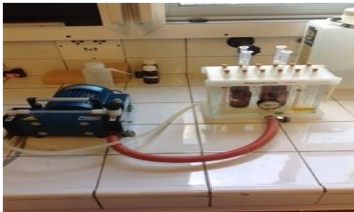
Figure II- 14 : L'appareil d'extraction en phase solide (SPE).
