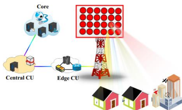
Figure 2. Réseau FWA utilisant un multiplexage MIMO (Multiple Input Multiple Output) et BF (beamforming) [3]
