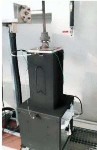
*Figure 2. 8 : Réacteur de conversion installé au laboratoire DSEE de l'IMT Atlantique*
