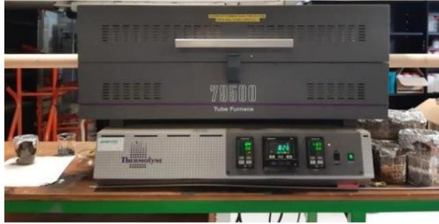
Figure 4. 2 : Four tri-tubulaire Thermolyne 79500
