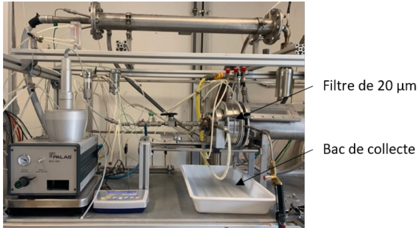
FIGURE 2.11 – Configuration du pilote pour effectuer la vidange de l'injecteur de solide
