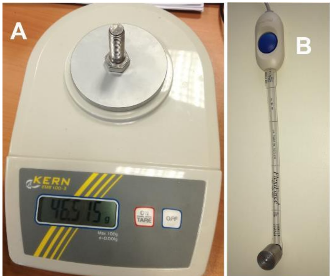
Figure 92, Calibration du capteur. A, premières tentatives. B, poids normalisés utilisés pour la calibration
