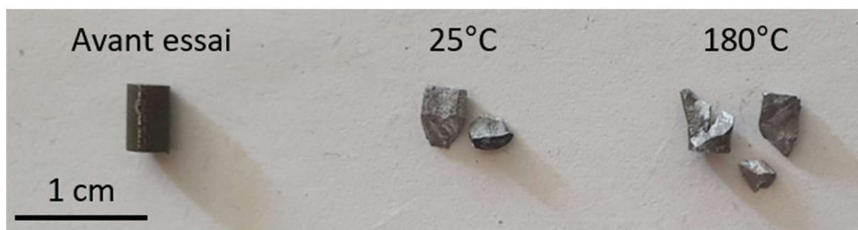
Figure IV-24 - Éprouvettes de compression cylindriques de l'alliage AS2, avant et après essais de compression à différentes températures (25 et 180°C).
