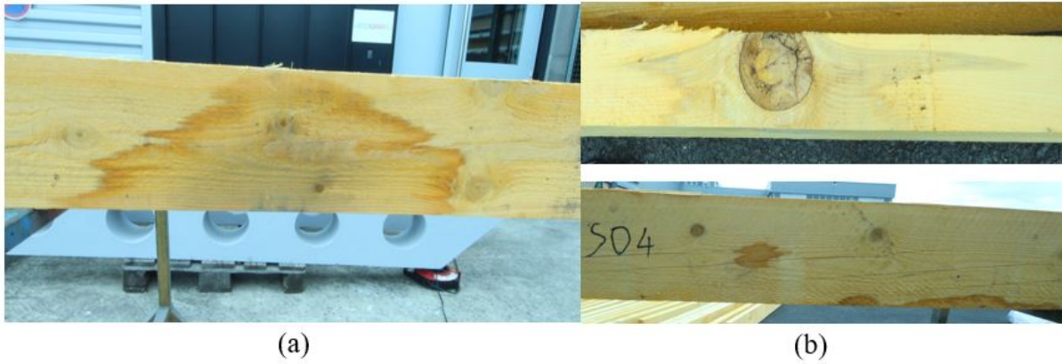
FIGURE C.5 – Photos des poches identifiées sur le lot de poutres : (a) poutre S03; (b) poutres S18 (haut) et S04 (bas).
