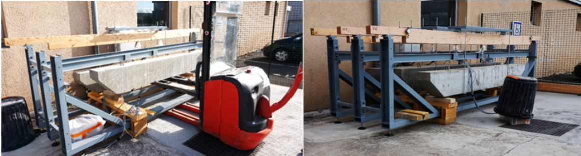
FIGURE 1.10 – Photos des essais de fluage de poutres entaillées en extérieur, issues de Pam-bou Nziengui (2019).
